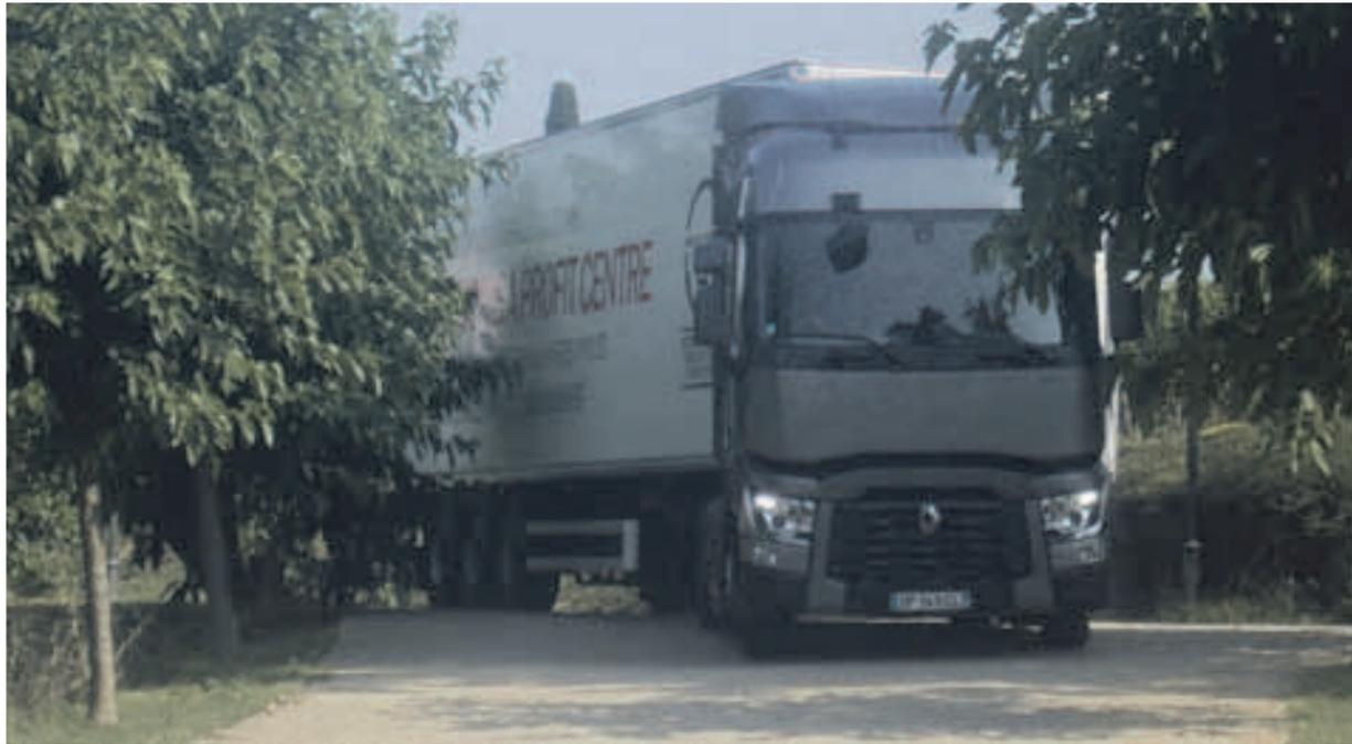
Qui e in basso, il Renault Trucks T Optifuel con motore DTI 11 da 460 cv utilizzato durante la competizione.
