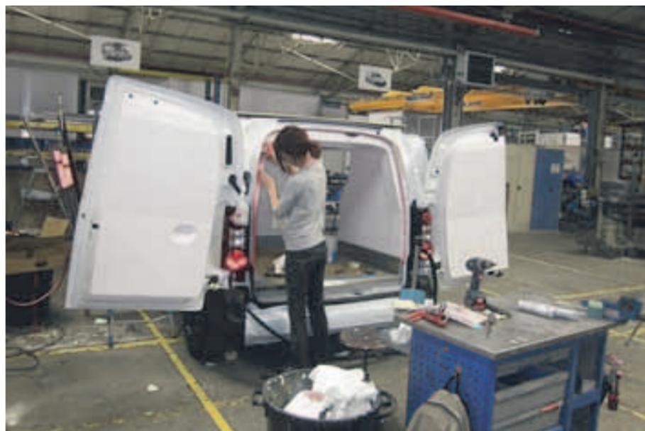
Di estrema precisione la fase di montaggio e fissaggio del sistema isothermico in un veicolo leggero.
