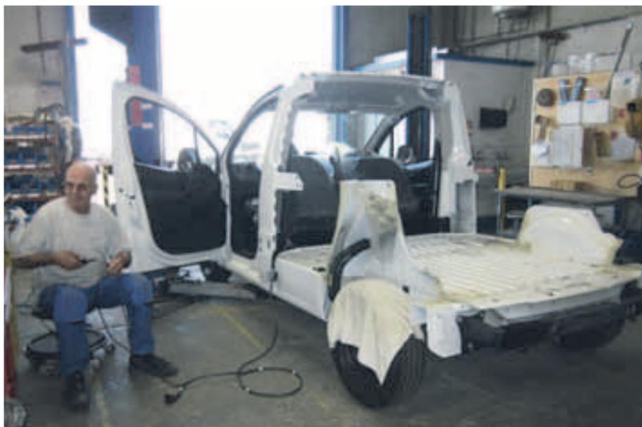
La fase di allestimento del vano posteriore di un veicolo commerciale.
