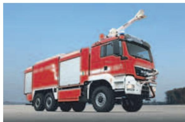
Per questo, hanno richiesto un autocarro MAN con motore da 400 cv accoppiato a una trasmissione automatica Allison della Serie 4000, in modo da affrontare agevolmente tratti tortuosi con forti dislivelli. Le nostre trasmissioni moltiplicano la coppia motore e trasferiscono la potenza in maniera continua assicurando spunto, accelerazione e controllo superiori, anche con carichi pesanti e su terreni difficili. Le prestazioni di questo autocarro da 400 cavalli sono senza pari".
