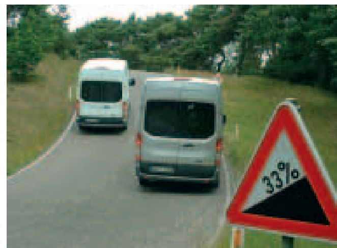
Una delle prove di resistenza a cui è stato sottoposto il nuovo Transit, qui impegnato su tracciato con pendenza del 33 per cento.
