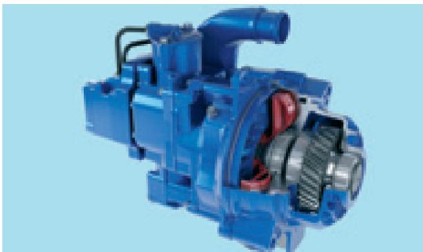
guadagno in termini di spazio è notevole e permette un aumento del carico utile trasportato di 35 kg. Il fluido di azionamento del dispositivo è il liquido di raffreddamento del motore, quindi non è necessaria alcuna manutenzione accessoria. Il retarder aumenta la potenza della pompa dell'acqua grazie alla sua integrazione nel circuito, garantendo un aumento della potenza frenante fino al 30 per cento.
