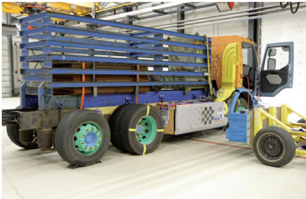
di carburante fino al 30 per cento. Il modello ibrido, che sarà principalmente adibito a eseguire funzioni nella distribuzione e nella raccolta dei rifiuti nelle aree urbane, è stato testato simulando un urto in cui una macchina colpisce il lato del pacco batterie a una velocità di 46 chilometri l'ora. "Si tratta - dice Carl Johan Almqvist - di un tipo d'incidente
