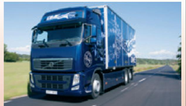
fornimento. Anche dal punto di vista del conducente, un camion Volvo alimentato a DME è perfettamente comparabile a un mezzo alimentato a diesel. Le prestazioni e le condizioni di guida sono virtualmente le stesse. Tuttavia, i camion alimentati a DME offrono una coppia leggermente più alta e il motore è più silenzioso. L'Unione Europea calcola che entro il 2030 il Bio-DME sarà in grado di sostituire metà del combustibile diesel utilizzato per il trasporto commerciale pesante.
