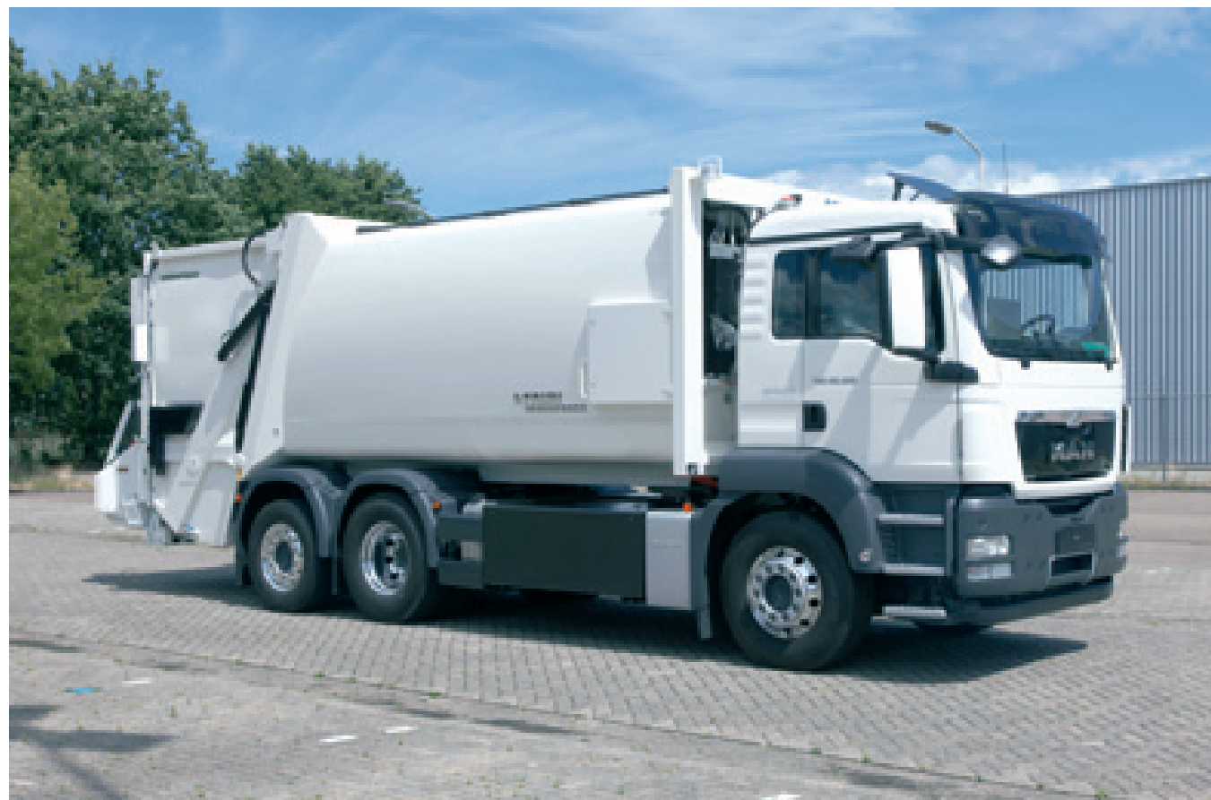
Il Man Metropolis è in grado di svolgere i suoi compiti di trasporto senza alcuna emissione di CO2. L'accumulatore di energia, una batteria agli ioni di litio di tipo modulare, è collocata sotto la cabina di guida a garanzia di massimi spazi per l'allestimento.
