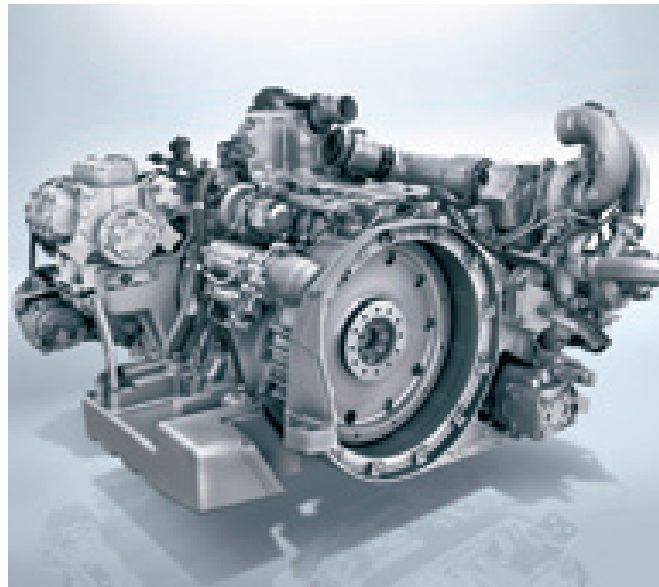
Il sei cilindri in versione orizzontale OM 936h, su misura per l'impiego nell'autobus di linea. La versione orizzontale è già stata considerata da Mercedes-Benz nella fase di progettazione. L'impegno costruttivo è tuttavia maggiore rispetto alla versione verticale.
