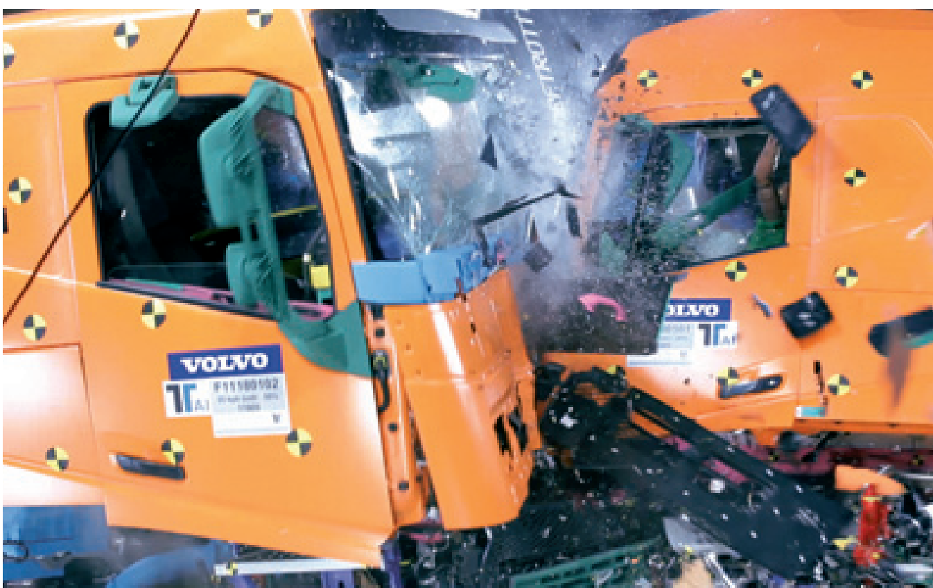
Uno dei test di collisione che hanno permesso a Volvo Trucks di sviluppare una cabina ancora più sicura rispetto agli standard precedenti.
