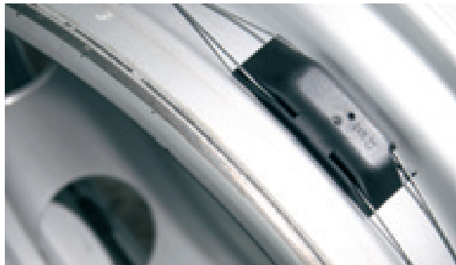
Il chip RFID rimane all'interno del pneumatico per tutte le sue vite (nuovo, riscoperto, ricoperto). Grazie a questa innovazione, Michelin può fornire informazioni affidabili e controllabili per tutto il tempo in cui il veicolo è equipaggiato con i suoi pneumatici.
