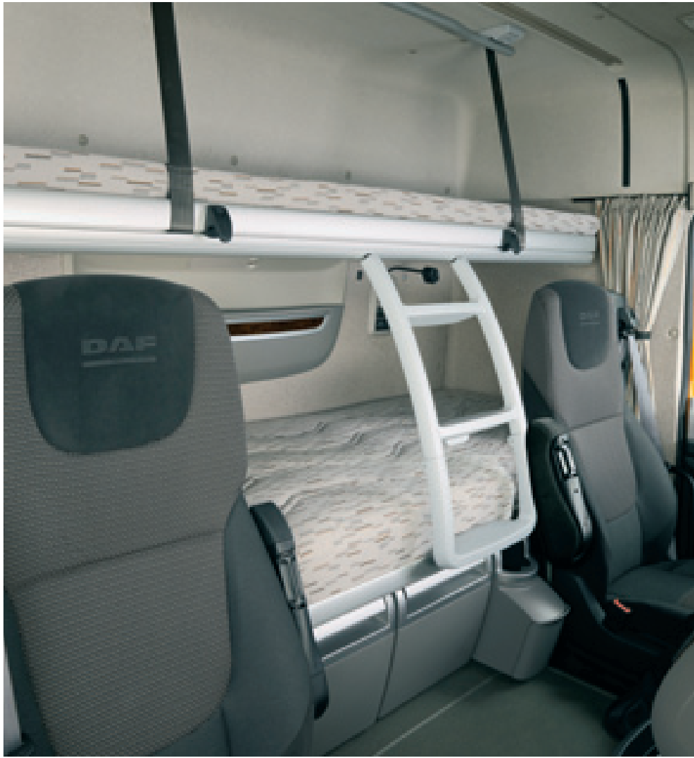
L'abitacolo del modello XF presenta numerosi miglioramenti. I nuovi sedili, con una vasta gamma di regolazioni, offrono un livello di comfort ancora più elevato. Il materasso del letto inferiore è lungo 2,20 m.
