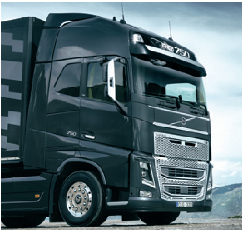
Volvo Trucks ha eliminato i gusci degli specchietti retrovisori a vantaggio della visibilità diretta.
