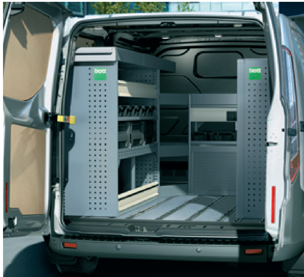
La capacità di carico del Transit Custom varia dai 600 kg del modello 250 ai 1.400 kg del modello 330. Il volume di carico del van Ford è compreso tra 6 e 6,8 metri cubi, rispettivamente con passo corto e lungo.
