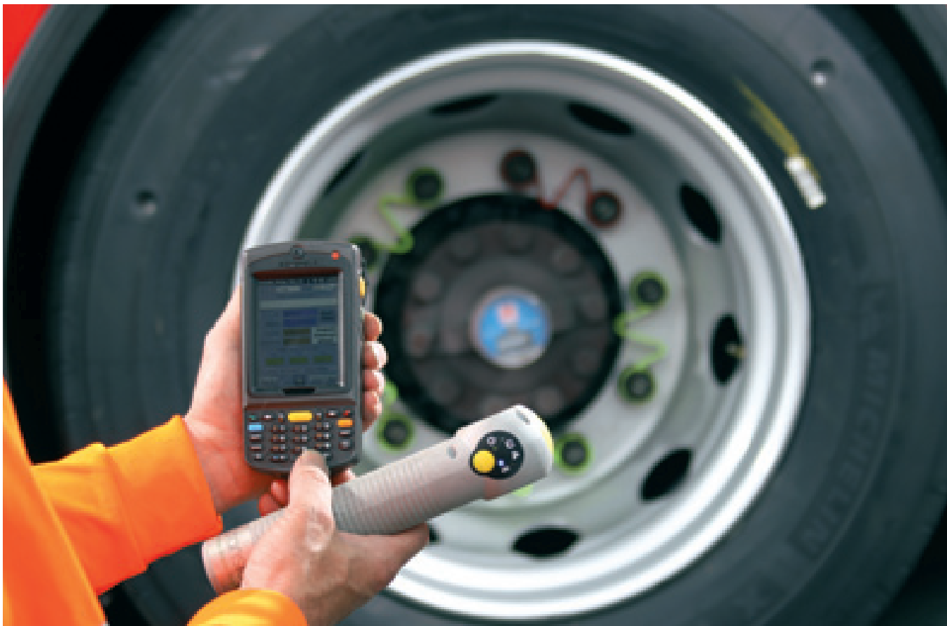
Il chip RFID rimane all'interno del pneumatico per tutte le sue vite (nuovo, riscoperto, ricoperto). Grazie a questa innovazione, Michelin può fornire informazioni affidabili e controllabili per tutto il tempo in cui il veicolo è equipaggiato con i suoi pneumatici.
