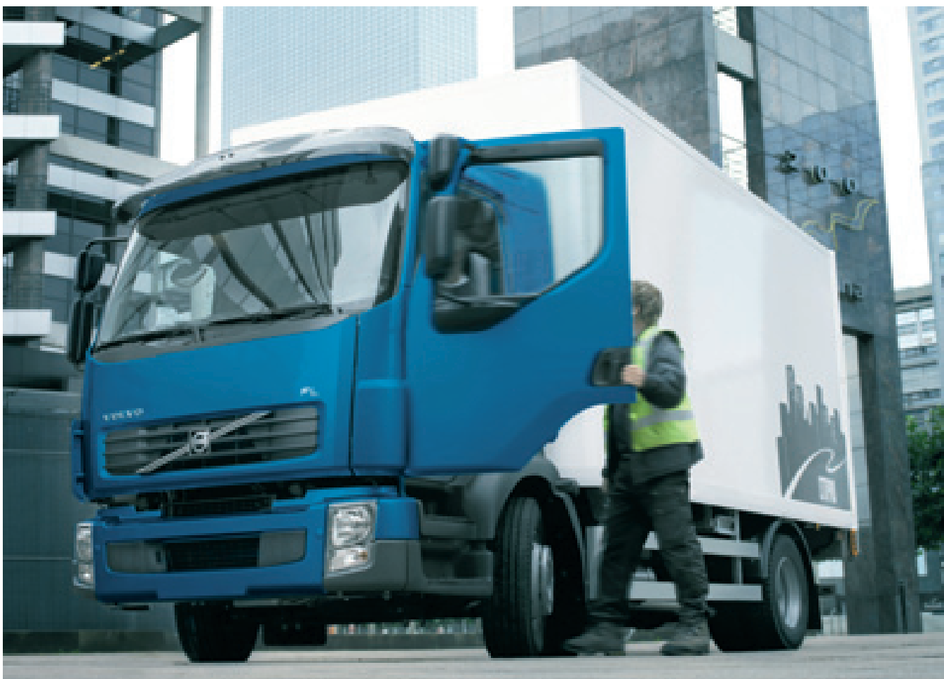
I medi FL nascono nel 2006. Su di loro Volvo proporrà due anni dopo i cambi meccanici integrati da un sistema a controllo elettronico degli inserimenti delle marce che chiamerà I-sync per distinguerli dagli I-shift, gli automatizzati di successo nel segmento pesanti.
