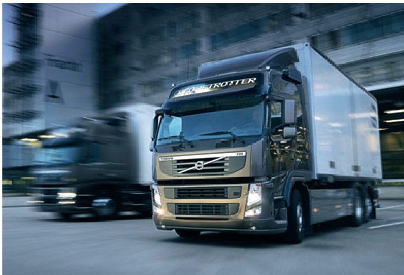
Dalla primavera del 2009 la serie FM è cresciuta di cilindrata a 11 litri dai 9 precedenti, mantenendo un propulsore a sei cilindri e accorciando le distanze con il fratello maggiore FH. Un salto tecnologico che testimonia la capacità innovativa del marchio svedese.
