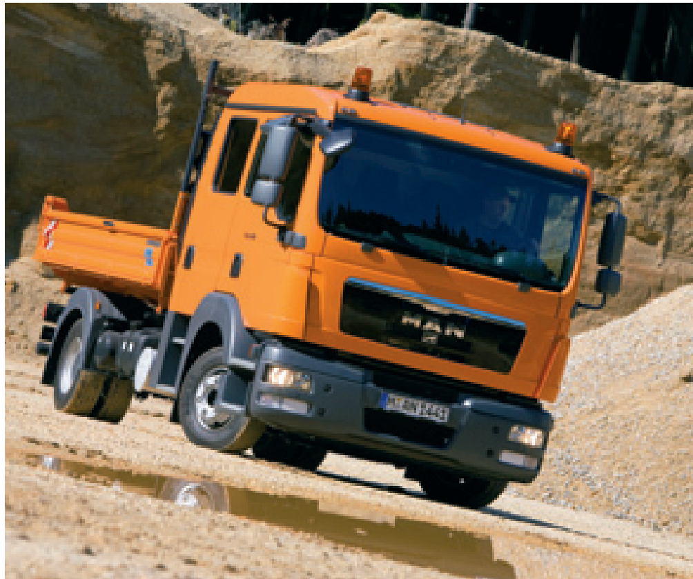
A fine maggio 2005 Man avvia le consegne del nuovo TGL (Trucknology Generation Light) che sostituisce la linea L2000 per pesi totali tra 7,5 e 12 t. Il cambio Tipmatic è parte del pacchetto.
