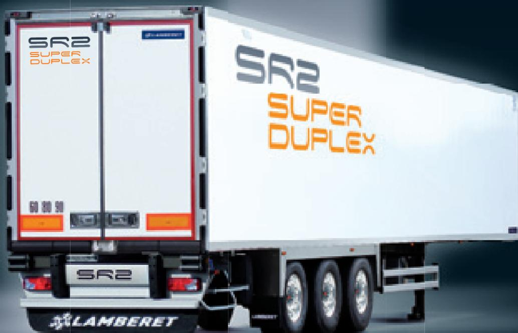
SR2 SUPERDUPLEx offre un carico di 66 pallet su due livelli senza rischio di ribaltamento grazie al telaio SUPERSTABLE (Premio per l'Innovazione Solutrans 2011). Offre un margine di sicurezza supplementare che respinge il limite di ribaltamento del 10% durante le curve.
