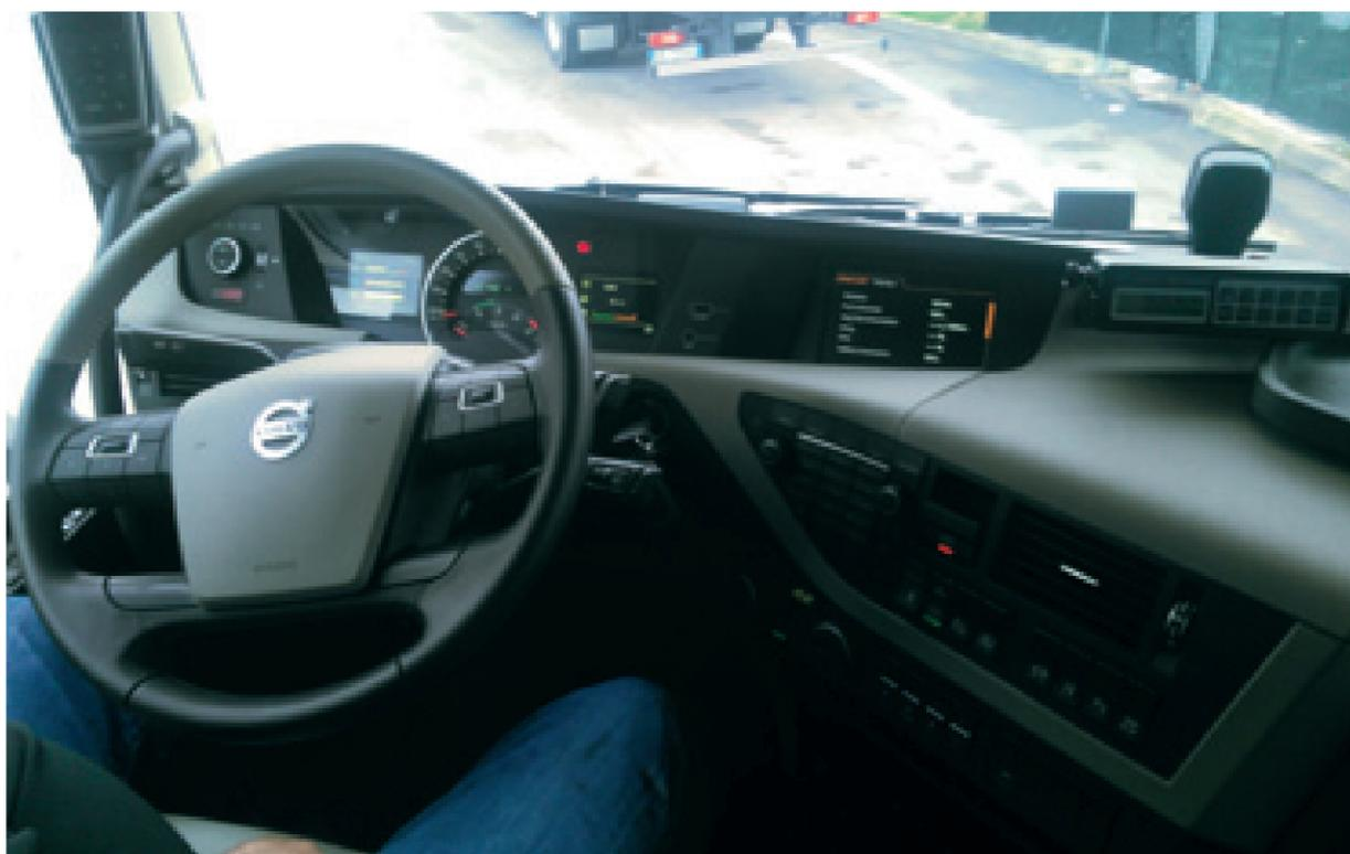
Molte delle funzioni dell'FH possono essere attivate tramite pulsanti sul volante, inclusi telefono e navigatore.
