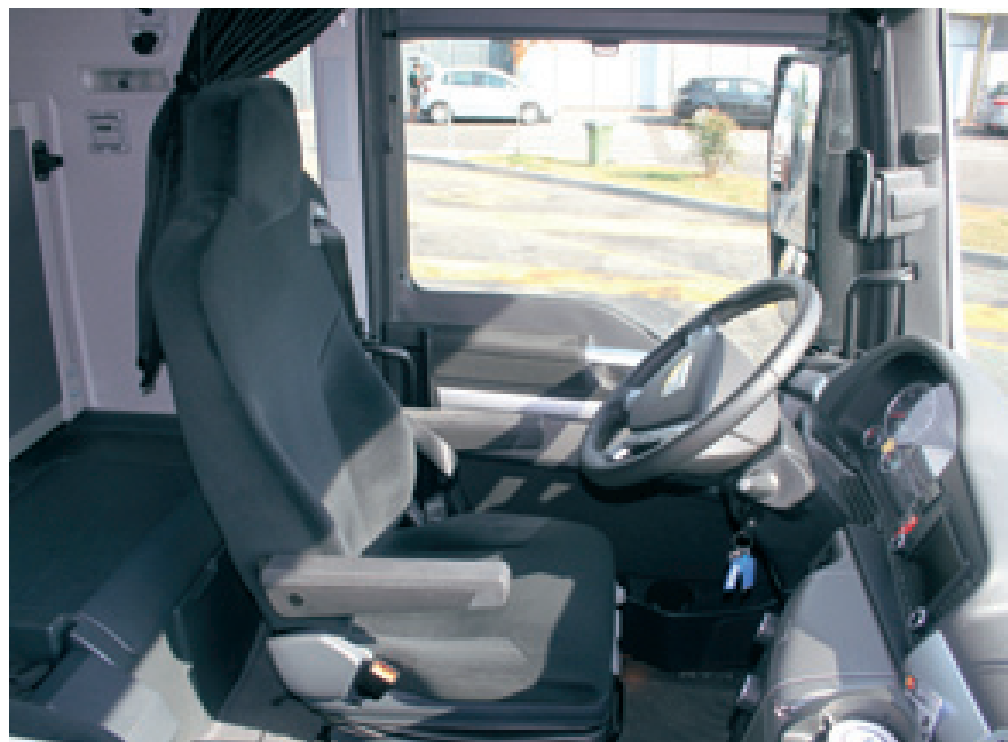
Il volante multifunzione consente di attivare anche ACC o Brensomat, così come il telefono cellulare o la radio senza staccare le mani dallo stesso. Una soluzione confortevole ed estremamente sicura.
