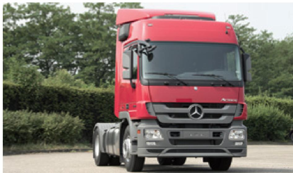
Per migliorare la resa dei nuovi modelli Eco Master dell'Actros sono state adottate le cabine HighSpace, quelle che garantiscono i migliori risultati aerodinamici, dotate di uno spoiler superiore.
