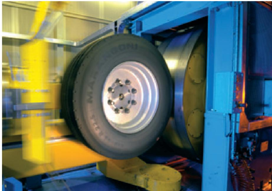
Le fasi di ricostruzione di un pneumatico sono 7. Il principio su cui si basa è la maggiore durata della struttura del pneumatico rispetto al battistrada, il cui spessore viene consumato dall'usura.
