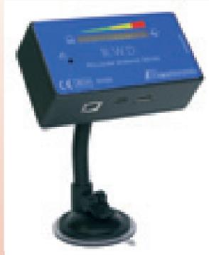
due elementi: un sensore posizionato nell'assale posteriore del rimorchio e un ricevitore installato in cabina. Il sensore monitora di continuo i movimenti laterali del rimorchio e invia al conducente segnali di avviso nel caso in cui fossero rilevati spostamenti anomali, come per esempio quando si affronta una curva a velocità elevata.
