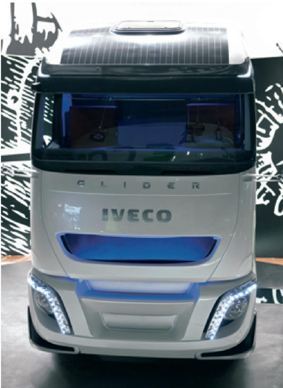
Glider è stato progettato per essere il più possibile aerodinamico alle alte velocità. Questo migliora il Cx dell'8 per cento e contribuisce a ridurre il consumo di carburante dell'1,5 per cento.
