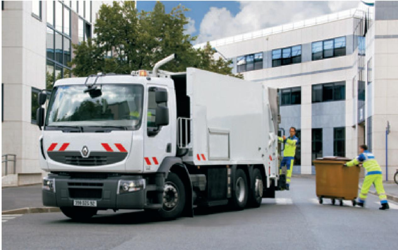
La gamma Premium Distribuzione di Renault Trucks si compone di 40 modelli di motrici 4x2 e 6x2 e trattori 4x2. Due le motorizzazioni e sei le potenze espresse: 270, 310 e 340 cavalli per il DXi7, 380, 430 e 460 cavalli per il DXi11.
