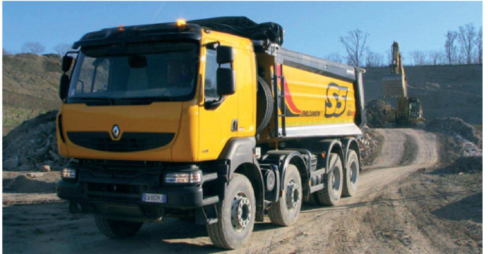
Il Kerax guadagna 20 importanti cavalli nella nuova configurazione Euro 5. Non è la sola novità del mezzo d'opera del marchio francese, che si arricchisce di un rallentatore che poggia adesso su di una base elettronica e si rivela più pronto alla risposta, oltre che di un software del cambio automatico, che è stato semplificato.
