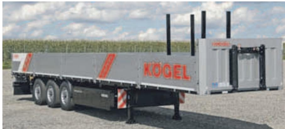
per ciascun anello, oltre a due coppie di anelli fermacarico nella parete anteriore in acciaio. Kögel Multi dispone ovviamente di una certificazione edile per il fissaggio del carico a norma DIN EN 12642 codice XL. Va poi precisato che l'intero telaio di Multi è protetto in modo duraturo dalla corrosione mediante la tecnologia nanoceramica abbinata a un rivestimento cataforetico con successiva verniciatura UV.
