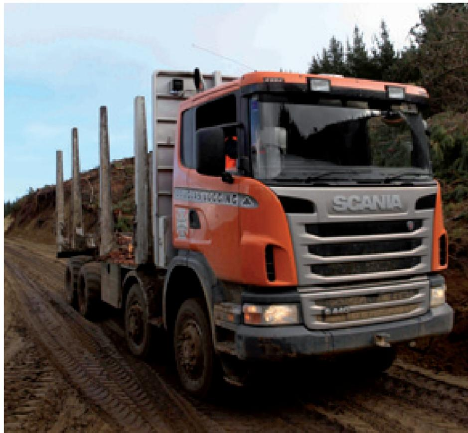
velocemente una marcia per mantenere trazione. Questo ha comportato un fermo macchina e la sostituzione del sincronizzatore, un problema che con l'Allison non avremo mai. Un altro problema che non avremo più è quello dell'usura della frizione, molto comune considerati il carico così ingente, le salite pronunciate e i terreni fangosi".
