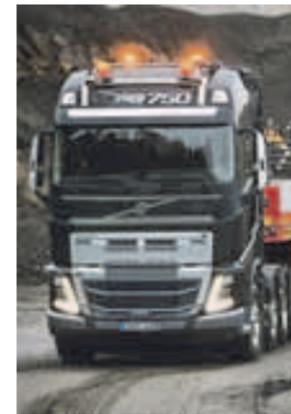
acciaio da 3 mm. Nel design è integrato un gradino fisso situato sopra la piastra in acciaio. La posizione elevata del paraurti contribuisce inoltre a migliorare l'angolo di attacco, che è di oltre 20 gradi sui veicoli con telaio extra alto per cantieristica, introdotto anche nel Volvo FH nel 2014. Un occhione di traino realizzato in ghisa, dotato di certificazione e progettato per gestire pesi di 36 tonnellate, è disponibile in opzione di fabbrica.
