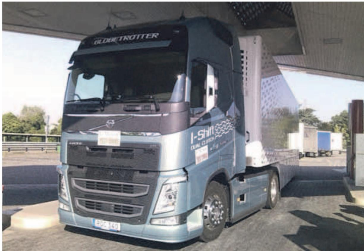
OLTRE 300 KM A BORDO DI UN TRATTORE 4x2 FH 540 EQUIPAGGIATO CON IL SEI CILINDRI IN LINEA D13 DA 12.8 LITRI, IN GRADO DI EROGARE UNA POTENZA MASSIMA DI 540 CV E UNA COPPIA MASSIMA DI 2.600 NM A 1.000-1.450 GIRI/MIN. CONSUMI SOTTO CONTROLLO E COMFORT ALTO DI GAMMA, ANCHE GRAZIE ALL'INNOVATIVO E AVANZATO CAMBIO A DOPPIA FRIZIONE I-SHIFT DUAL CLUTCH.
