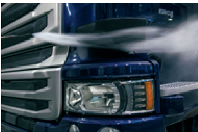
Lo speciale deflettore canalizzato posizionato sopra la fanaliera anteriore. È una soluzione brevettata dal costruttore svedese.
