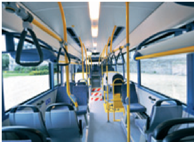
La parte anteriore ribassata beneficia di un'altezza interna di 2,56 m.
