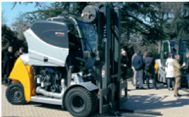
Il carrello RX70-80 è dotato di motore diesel e tecnologia ibrida.
