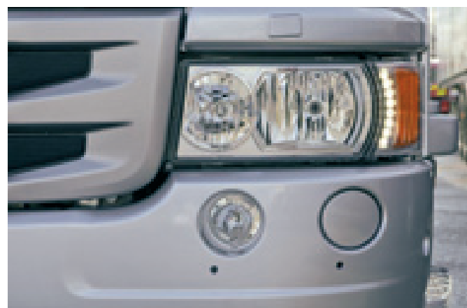
I nuovi fari H7 forniscono un fascio di luce più ampio rispetto agli H4. Rappresentano una delle alternative di punta dell'offerta Scania .
