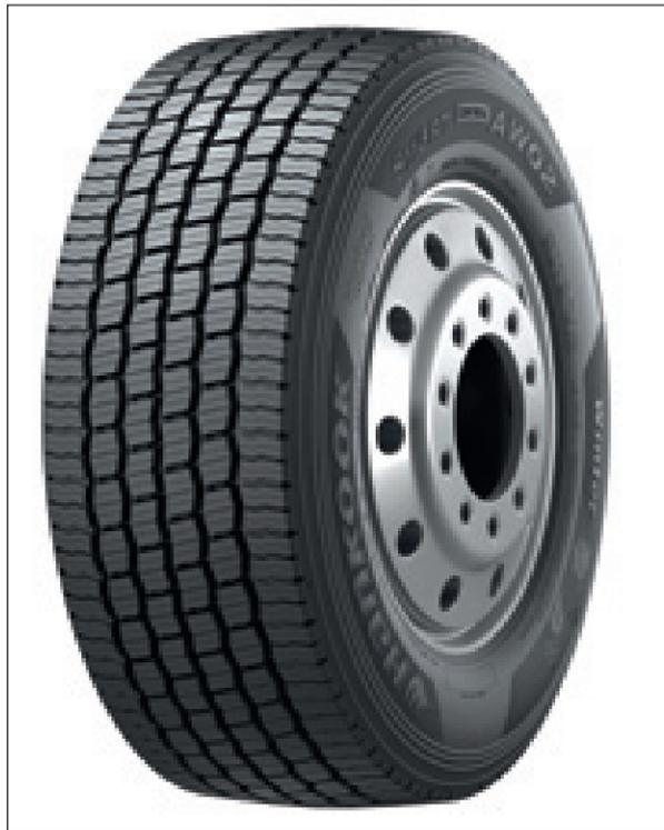
3 cime) e vanta uno schema con un ampio design del battistrada e della spalla - unitamente alle tacche a 3D - per assicurare una maggiore percorrenza, delle buone prestazioni di tenuta e un'usura irregolare ridotta al minimo. La tecnologia Hankook Tread Wear Equaliser Stepper (T.W.E.S.), applicata allo schema del design del blocco del pneumatico, permette di
