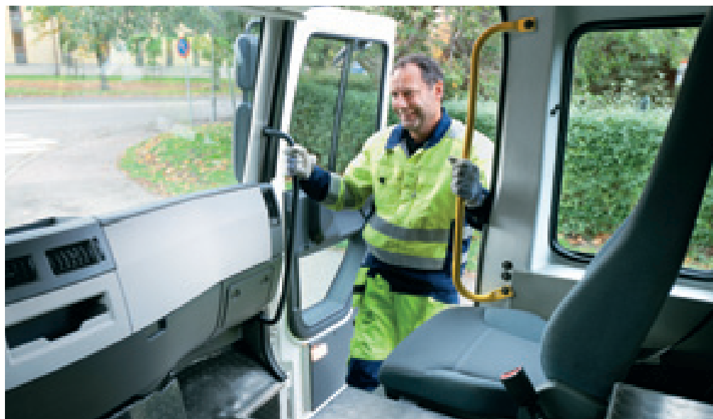
Nella versione Volvo FE LEC l'entrata ribassata è una delle caratteristiche salienti della cabina.
