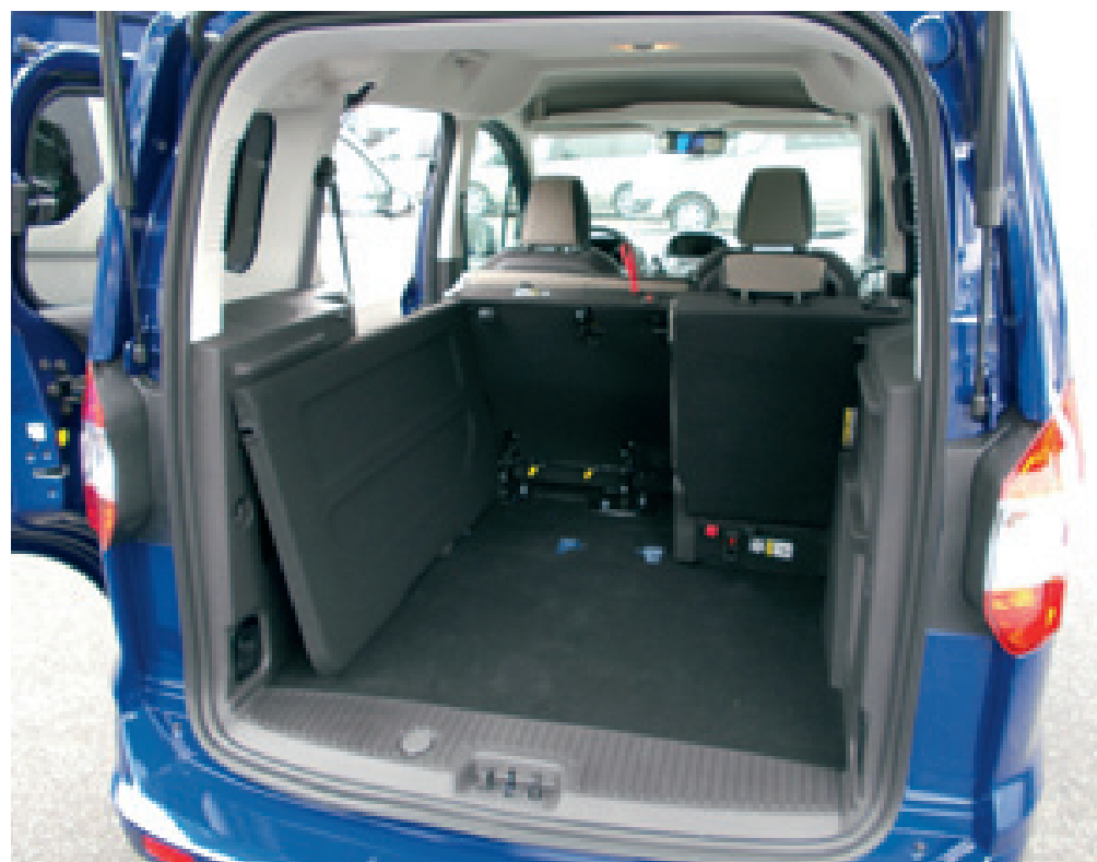
Tourneo Courier, largo poco più di 2 metri, alto 1,72 metri e con un passo di quasi 2,5 metri, è stato costruito sulla base della piattaforma globale B di Ford, la stessa condivisa da Fiesta e B-Max.
