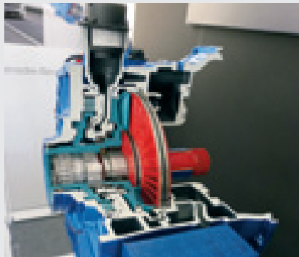
Il Turbo Retarder Clutch realizzato da Voith in collaborazione con Mercedes-Benz.
