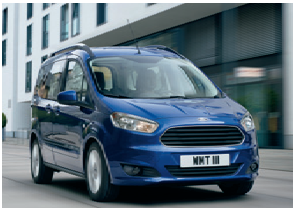
Tourneo Courier, largo poco più di 2 metri, alto 1,72 metri e con un passo di quasi 2,5 metri, è stato costruito sulla base della piattaforma globale B di Ford, la stessa condivisa da Fiesta e B-Max.
