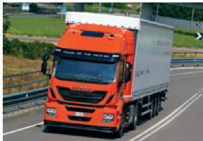
Uno Stralis Euro 6 equipaggiato con motore Cursor 8 Natural Power.
