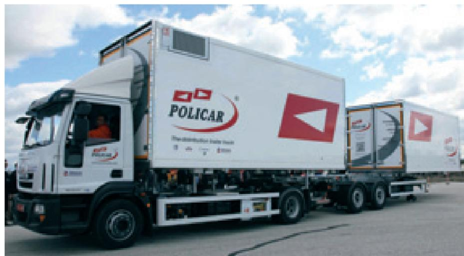
con casse isotermiche e gruppi frigoriferi multi-temperatura, il rimorchio è in grado di trasportare alimenti secchi, freschi o refrigerati, risultando particolarmente adatto alle diverse esigenze degli operatori del settore della distribuzione, dove tra l'altro la domanda di trasmissioni automatiche con convertitore di coppia sta vivendo una crescita costante.
