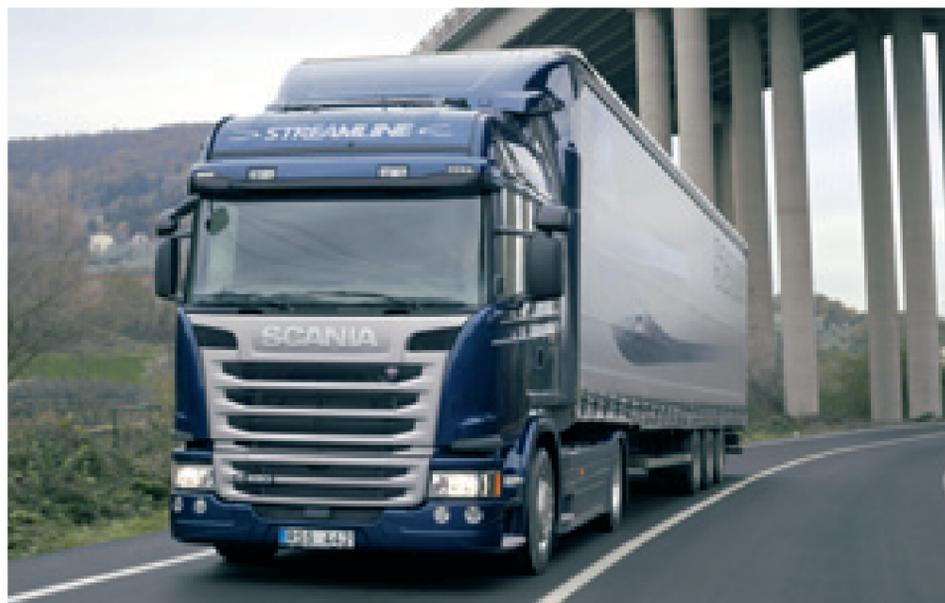
Gli spigoli della cabina sono stati smussati per trasmettere il flusso d'aria con la minima resistenza.
