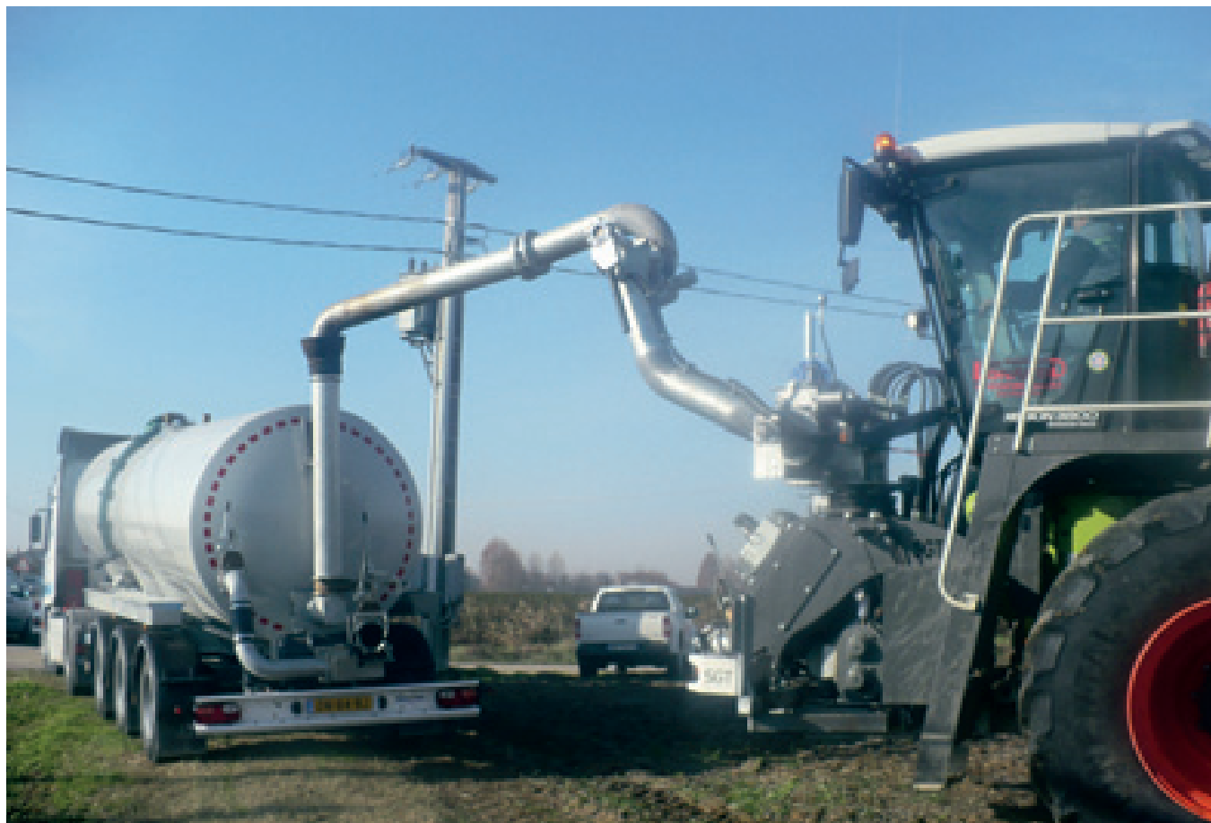
Il trattore Claas Xerion 3800 preleva il contenuto della cisterna autoportante D-TEC. Sotto, primo piano del trattore stradale Mercedes-Benz.
