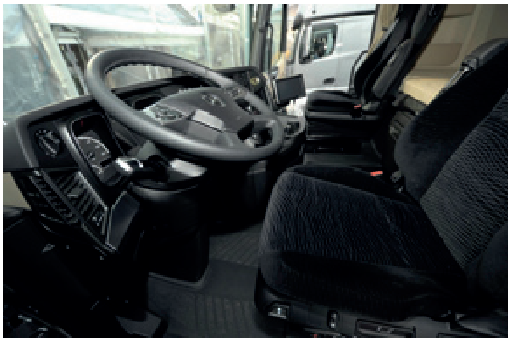
La cabina dell'Actros, studiata per il trasporto a lungo raggio, è disponibile in larghezze da 2,3 e 2,5 metri e con quattro varianti di tetto. Fra le sette varianti di cabina, 5 offrono il pavimento piatto.
