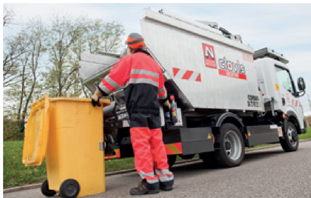
Il Maxity ha un carico utile fino a 1.895 chili. L'autonomia media può arrivare a 100 chilometri.
