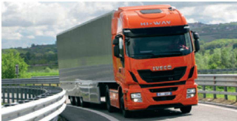
Gli Stralis Natural Power LNG sono equipaggiati con motore Cursor 8 CNG Euro 6 da 330 cv, hanno un serbatoio criogenico LNG da 510 litri e 4 serbatoi CNG da 70 litri che permettono un'autonomia di oltre 750 chilometri, consentendo così il loro impiego anche sulla media e lunga percorrenza. I vantaggi dell'utilizzo dei veicoli alimentati a gas naturale sono
