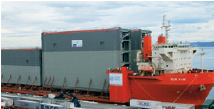
Le operazioni di trasporto delle 16 paratoie utilizzate per l'ampliamento del Canale di Panama.
