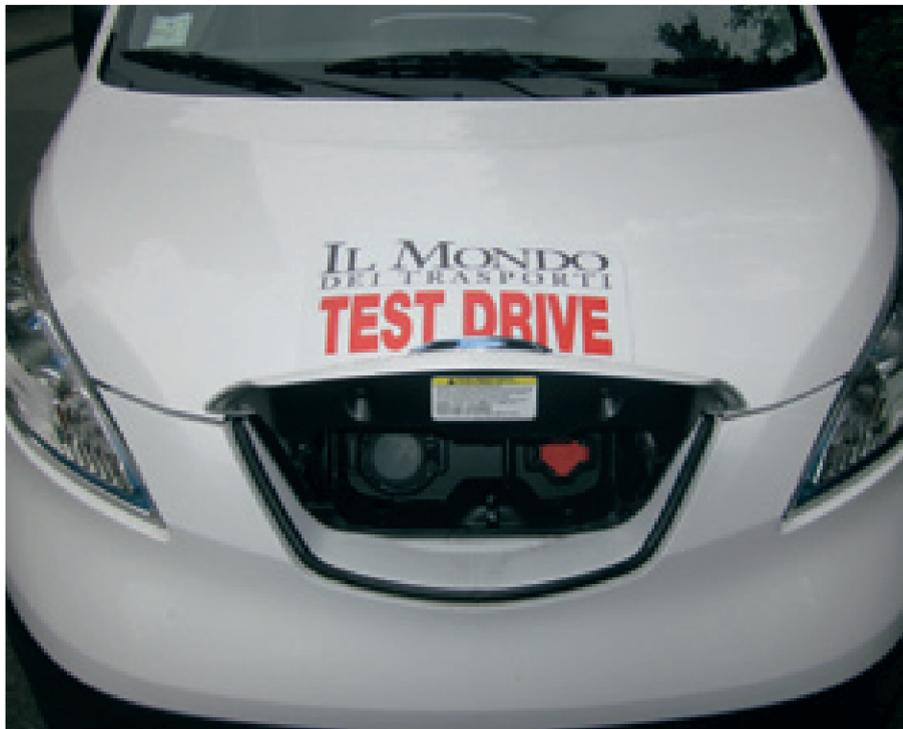
Il vano di rifornimento dell'energia elettrica consente la ricarica notturna via cavo nel box di casa.
