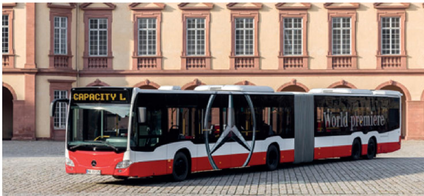
Con quasi 21 metri di lunghezza, il Mercedes-Benz CapaCity L misura circa 1,5 metri in più del suo predecessore e 2,9 metri in più di un Citaro G.
