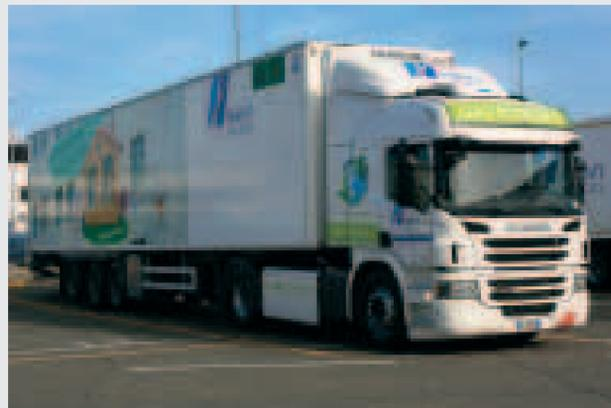
principali inquinanti rispetto ai motori Euro 5) vengono superati con un ulteriore abbattimento del 39 per cento degli ossidi di azoto e del 68 per cento del particolato. Oltre a ciò il motore a metano è più silenzioso del doppio (meno 3 dB) rispetto ai pari caratteristiche diesel.
