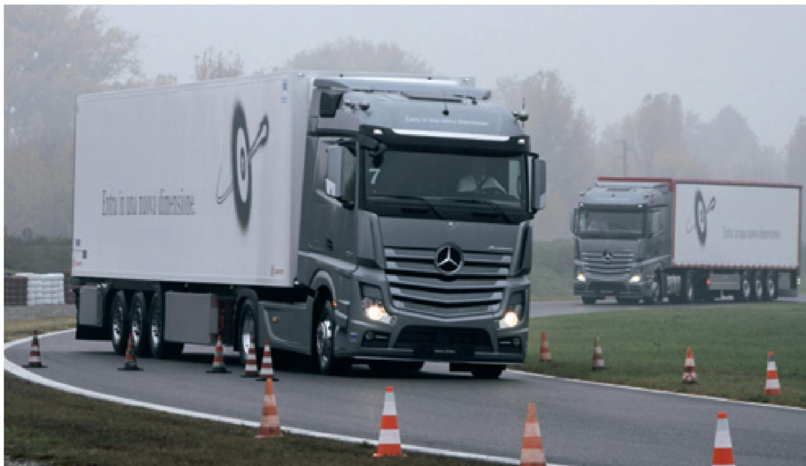
*Il nuovo Actros aggiunge alle potenzialità del propulsore una dinamica di marcia che non ha oggi paragoni, merito in particolare del telaio completamente ridisegnato, ampliato nelle dimensioni e reso più resistente alla torsione, come si è visto molto bene nelle prove di slalom effettuate su pista.*
