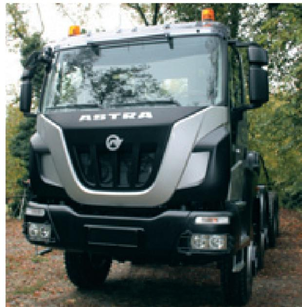
La nuova cabina dell'Astra HD9 è in acciaio trattato, che ha sostituito la soluzione composita dell'attuale modello.
