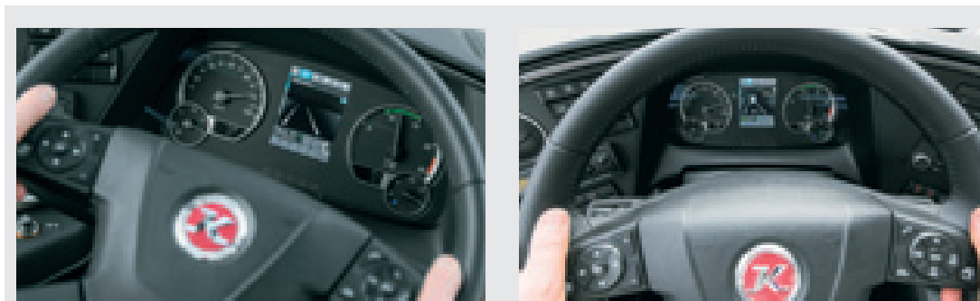
Aiuto prezioso A sinistra, il cruscotto del Setra TopClass 500 con l'indicazione di PPC disattivato, a destra con il dispositivo inserito.
