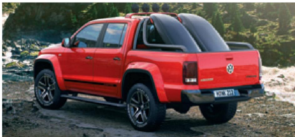
Il telaio dell'Amarok Canyon è stato rialzato di 40 mm grazie a kit "body lift" e, compresi i pneumatici, il veicolo è più alto di 85 mm. Sul tetto è presente una staffa con quattro fari supplementari (a sinistra).
