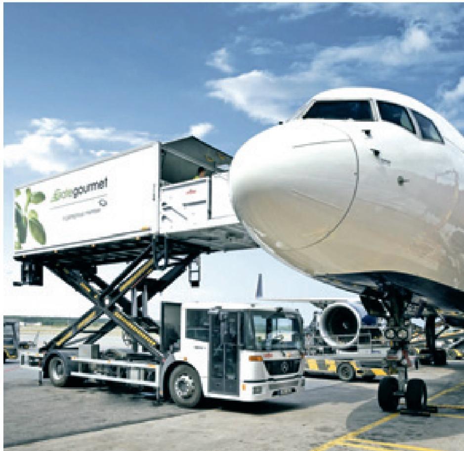
Completati di piattaforme elevatrici a pantografo, gli Econic di Gate Gourmet sono in grado di servire tutti i tipi di aeromobili in transito presso lo scalo di Stoccolma senza ricorrere a un altro veicolo.
