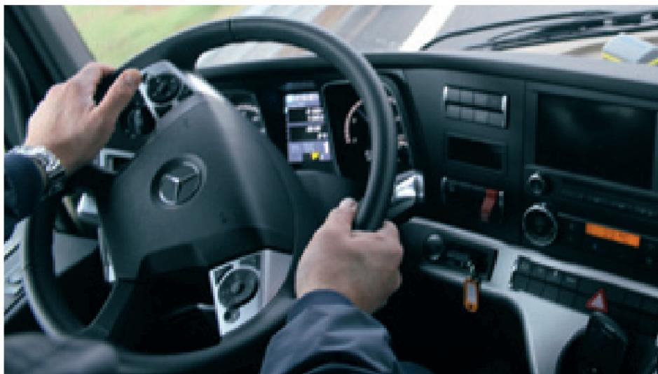
La leva del cambio e del Retarder non è più sul piantone dello sterzo ma alla destra del volante.
