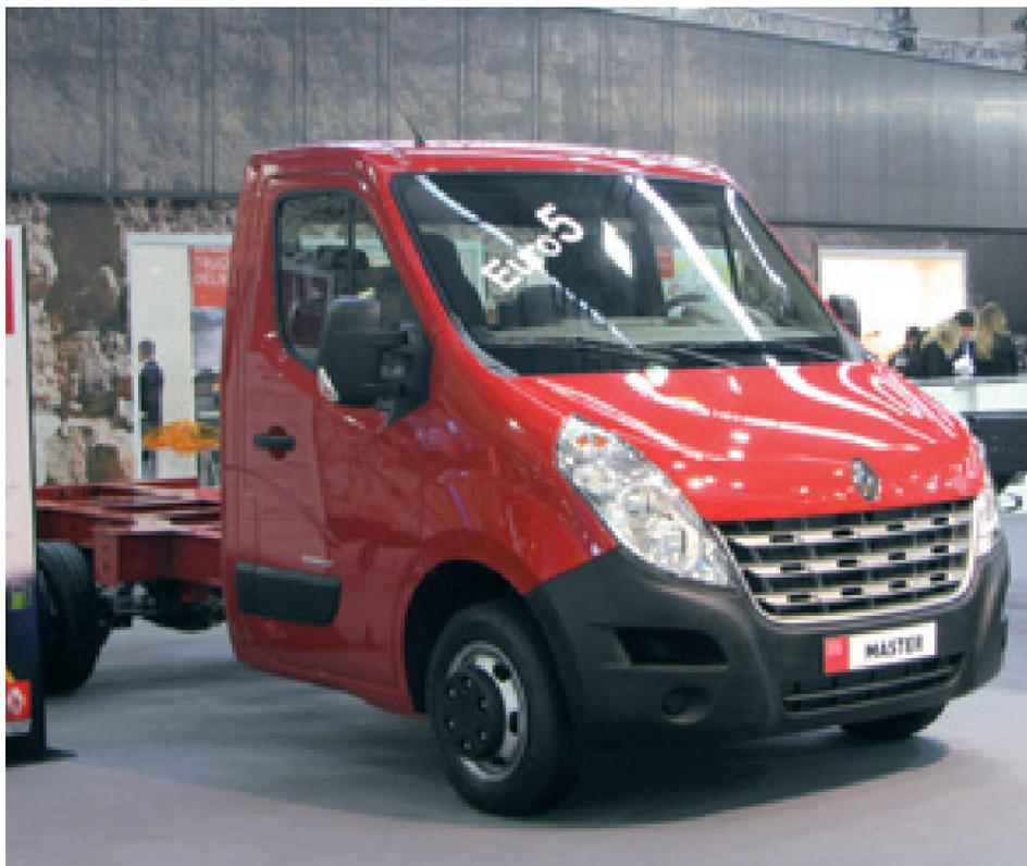
Sopra, il Master con trazione posteriore e ruote gemellate sul secondo asse.
