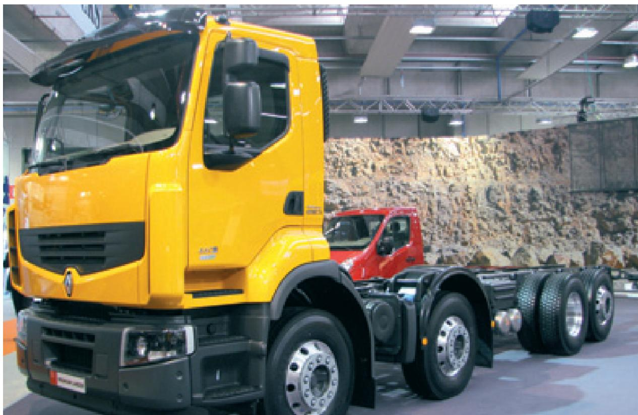
Con l'aggiunta di due motori pneumatici integrati nei mozzi delle ruote, il Premium Lander Optitrack si trasforma in un 4x4 senza dover subire le limitazioni di una soluzione integrale vera e propria. Ciò si traduce in un maggior carico utile e in consumi ridotti.
