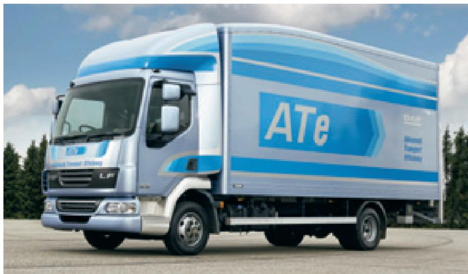
Il Daf LF45 ATe Aero propone un particolare cassone dalle forti caratteristiche aerodinamiche.
