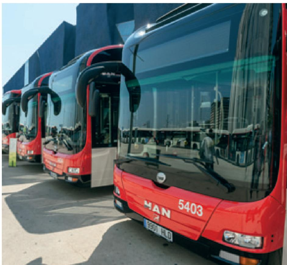
I Man Lion's City Hybrid lunghi 12 metri sono azionati da 2 motori elettrici con potenza di 75 kW.
