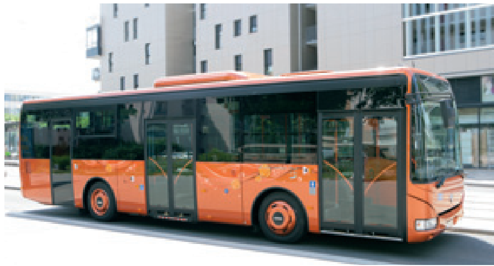
Il Crossway Low Entry esposto al Salone della mobilità è lungo 10,8 m. Cuore del veicolo il motore Tector 6 EEV da 264 HP (194 Kw). Il cambio è un Voith automatico. A bordo 27 sedili.
