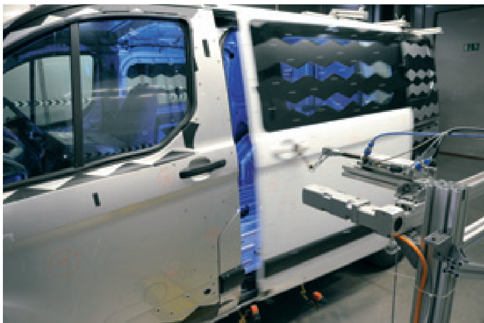
Le prove di resistenza delle porte del Ford Transit Custom sono state prodotte senza interruzioni per diversi mesi all'interno di speciali strutture per la simulazione di condizioni termiche estreme.
