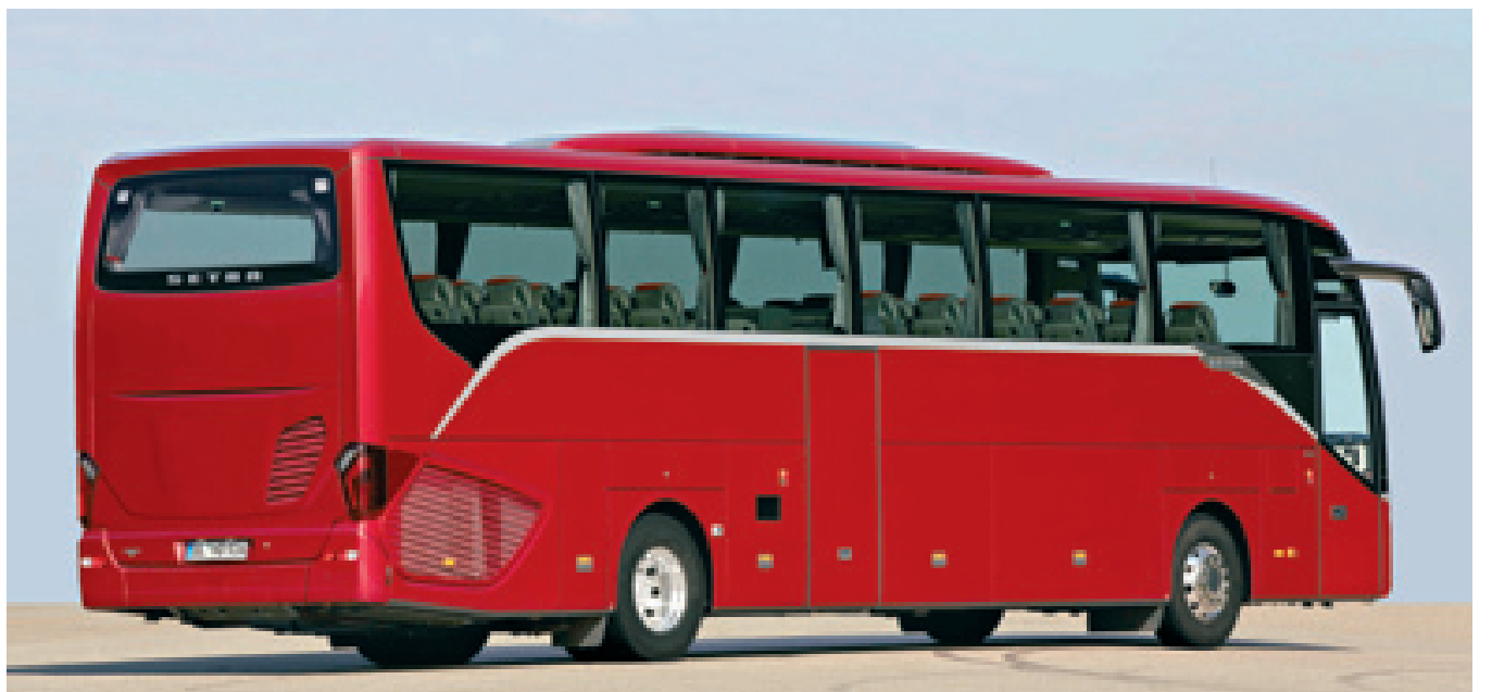
A conferire una nuova immagine al ComfortClass 500 contribuisce anche la cosiddetta coda "Aero". Dato che l'alloggiamento del nuovo propulsore Euro 6 ha richiesto un nuovo sistema di sfiatione per il vano motore, con una sola apertura sul lato destro i tecnici Setra hanno volutamente puntato su una forma asimmetrica del funzionale portellone posteriore come visualizzazione del nuovo layout del motore.
