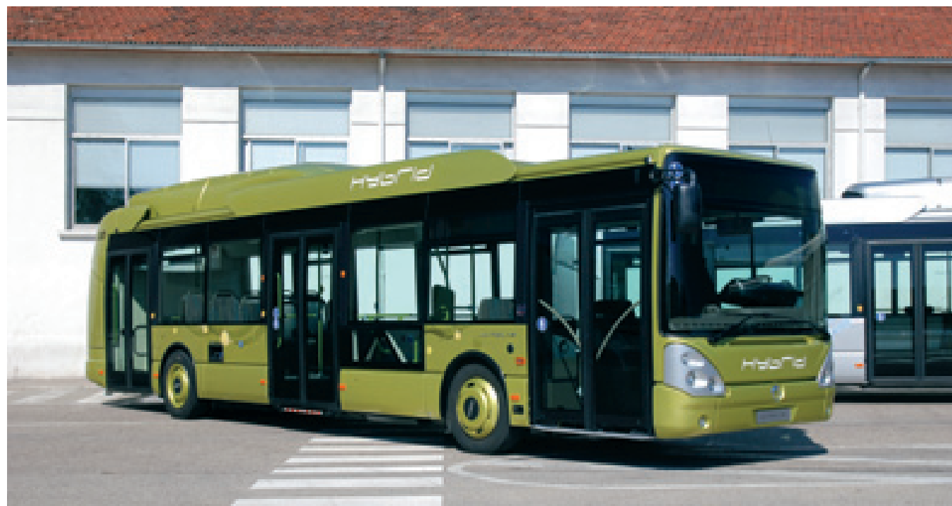
Al Salone "Transports Publics 2012" di Parigi, dedicato in toto alla mobilità, era esposto un Citelis in versione ibrida da 12 m, con motore termico Tector 6 300 HP (220 Kw) e motore elettrico da 175 Kw, senza cambio/ibrido seriale. A bordo 26 posti a sedere.
