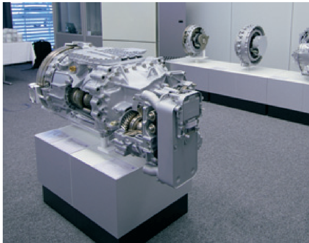
Il design da cambio modulare di TraXon permette di combinare la trasmissione di base con tre moduli. Ciò consente ai costruttori e operatori delle flotte la migliore scelta possibile per ogni applicazione.
