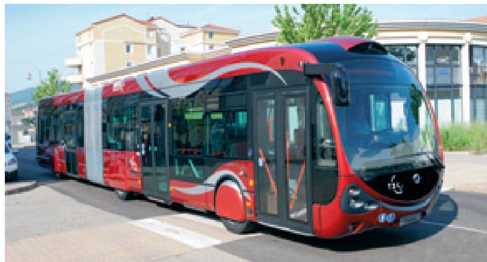
Il Crealis Neo da 18 m presentato a Parigi nella versione Clermont Ferrand. Monta un motore Cursor 8 EEV senza FAP da 380 cv e cambio ZF 6 HP 604 C. A bordo 35 sedili e due posti per sedia a rotelle.
