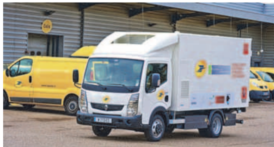
Il Maxity alimentato con cella a combustibile funzionante a idrogeno in dotazione a La Poste.
