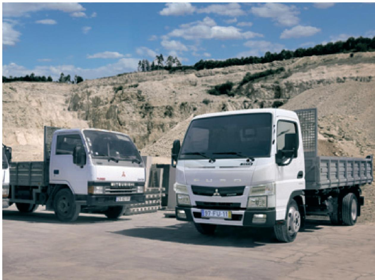
Con un peso totale ammesso rispettivamente di 3,5 tonnellate, 6 t e 7,5 t, Canter copre tutti i principali segmenti degli autocarri leggeri. L'alternativa 6 tonnellate è completamente nuova. Sono stati anche ridefiniti i carichi ammessi sugli assi e le configurazioni del telaio.
