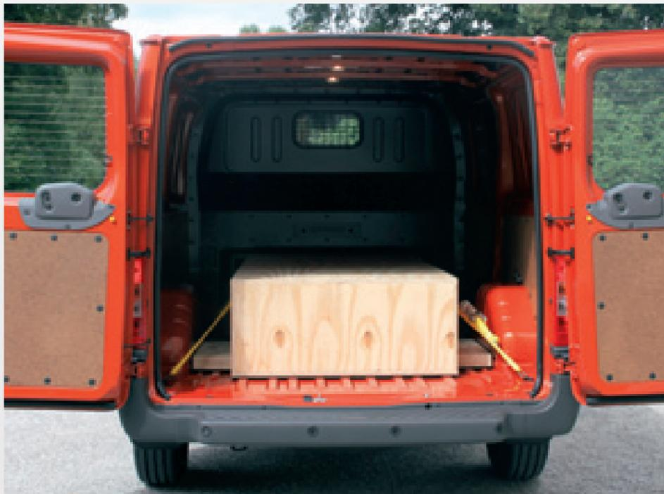
Sono ampie le possibilità di utilizzo del versatile **Transit**: per le versioni furgone il vano di carico va dai 6,5 ai 14,5 metri cubi, con in pratica la possibilità di caricare da 3 a 5 europallet.
