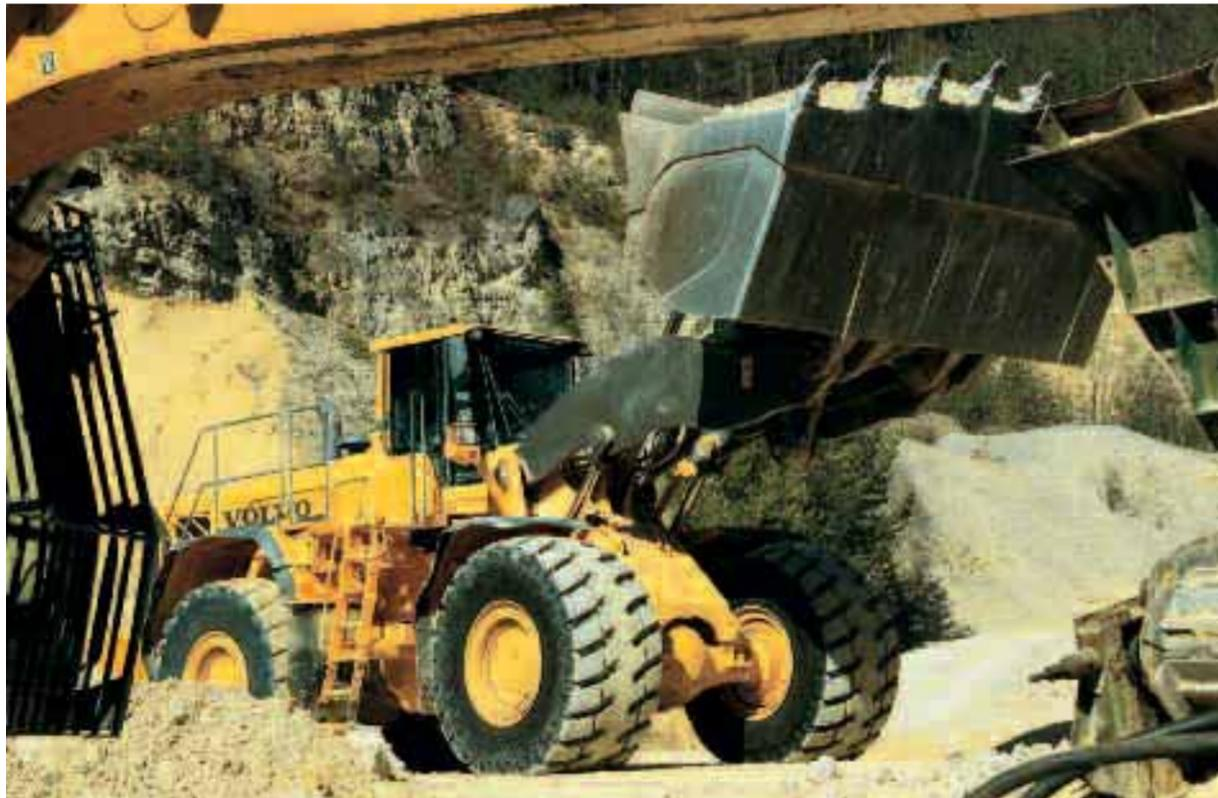
a 8 bar e permette di trasportare carichi maggiori. Lo pneumatico è anche in grado di trasmettere fino al 20 per cento in più di potenza grazie alla tecnologia B2: la nuova architettura della zona del tallone riduce il rischio di rotazione sul cerchio grazie a una superficie di contatto più larga del 30 per cento, sempre in rapporto all'XLDD1.
