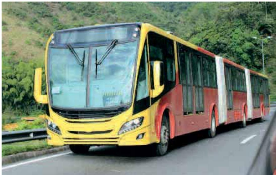
gena. Test indipendenti hanno dimostrato la loro capacità di svolgere tragitti ad alta quota senza perdita di potenza e coppia. Il funzionamento del veicolo a gas consente di ridurre notevolmente le emissioni di parti-
