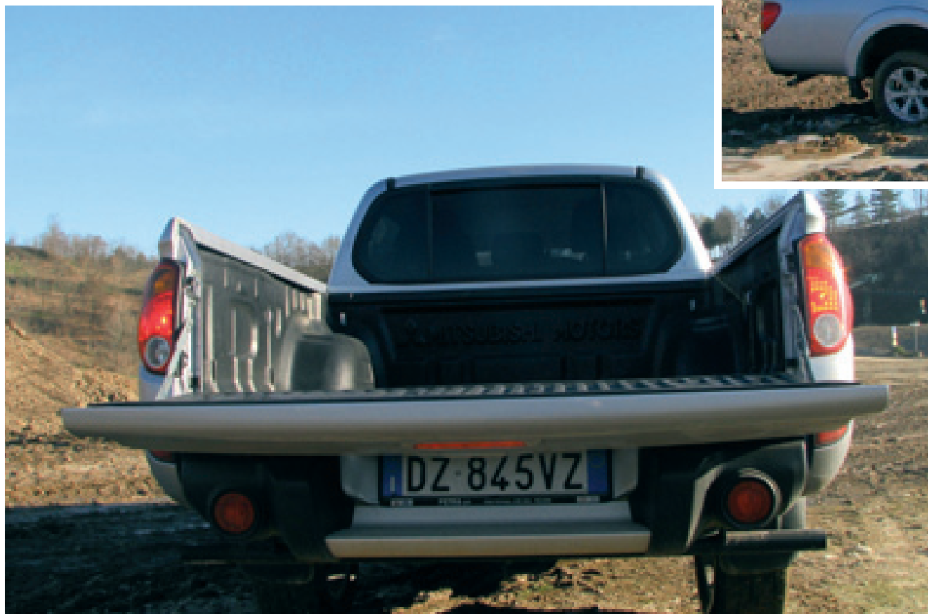
Il cassone posteriore ha dimensioni ridotte per l'effetto della doppia cabina, ma anche una buona profondità e una portata, conducente compreso, che sfiora la tonnellata. Mitsubishi L200 vanta un'altezza da terra sufficiente a prevenire fastidiose rotture.
