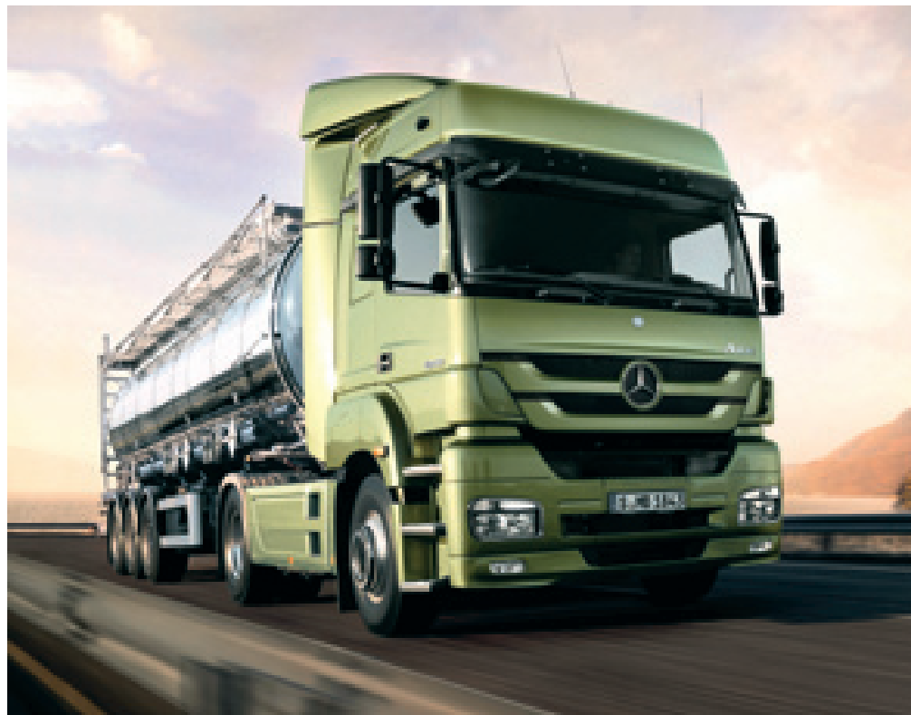
Mercedes-Benz Axor , anche se non presenta versioni specifiche per l'uso in cantiere, può essere facilmente equipaggiato con un ribaltabile. Le portate variano da 18 a 26 tonnellate.
