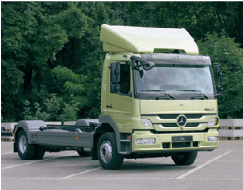
Atego propone motorizzazioni a quattro e sei cilindri; nel primo caso le potenze vanno da 156 a 238 cavalli mentre il 6 cilindri è proposto unicamente con 286 cv e una coppia di 1.120 Nm.
