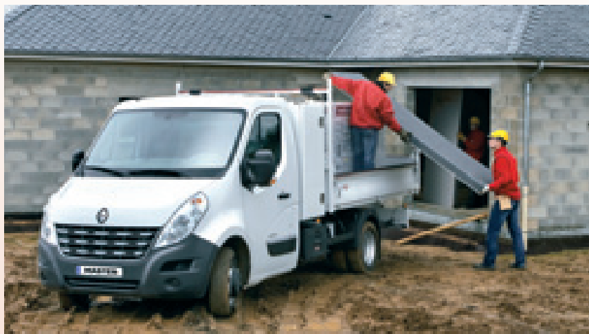
Per un utilizzo ottimale in cantiere il nuovo Master propone la trazione posteriore, in particolare con ruote gemellate. In basso, il Maxity, che può ospitare piccoli cassoni.
