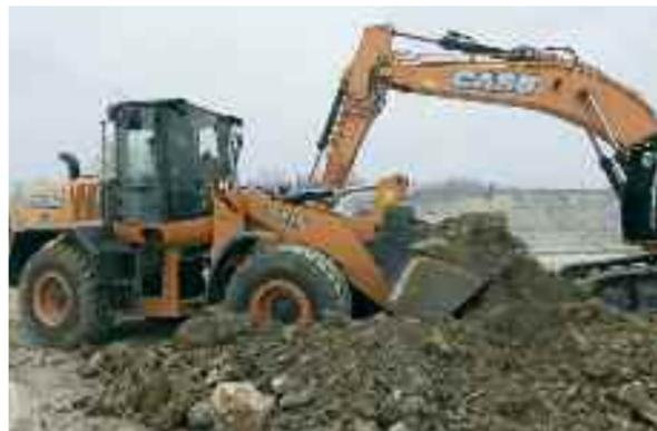
La pala che comanda 721F con motore da 124 kW e peso operativo da 14,5 t. A sinistra, la manipala compatta SR160.
