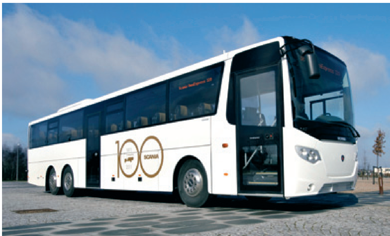
La forma a cuneo della parte anteriore della carrozzeria, interamente in acciaio inox, migliora ulteriormente l'aerodinamicità dello Scania OmniExpress 3.20. Il corridoio (foto a destra) è di 10 centimetri più ampio rispetto ai modelli più alti.
