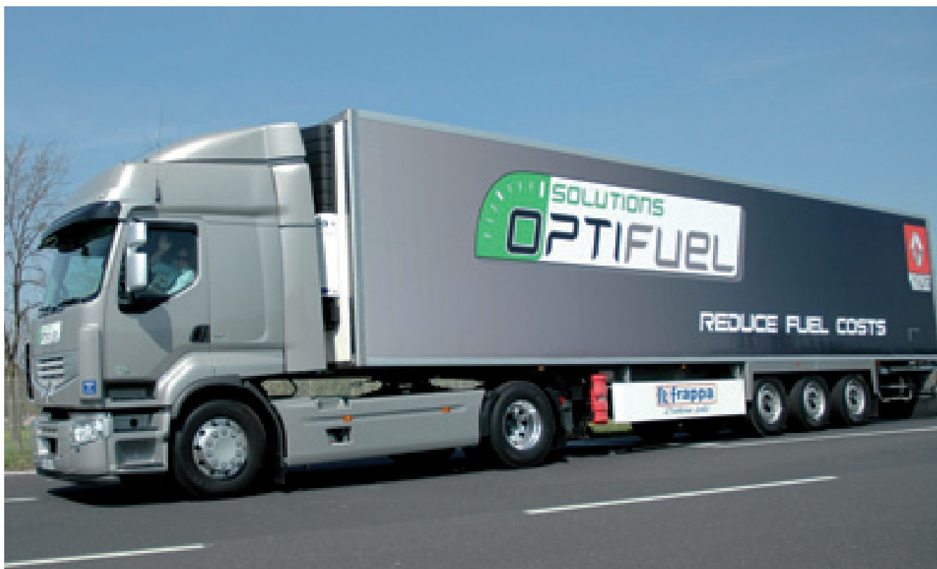
Il Renault Premium Strada trattore nella sua versione da 460 cv, con il motore ottimizzato in tutte le sue parti mobili, ed equipaggiato con il cambio automatizzato Optidriver+, privato però della modalità power, è il veicolo ideale a esprimere l'innovativo concetto di Optifuel.
