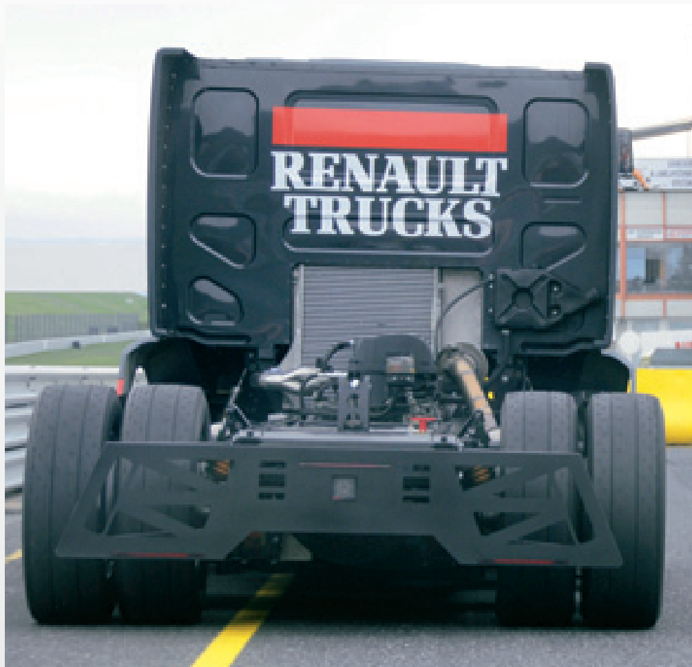
Il Premium Corsa impegnato nel Truck Racing 2011 dispone di motore Renault DXi 13 Racing che sviluppa una potenza di 1.140 cv con una coppia 5.500 Nm.
