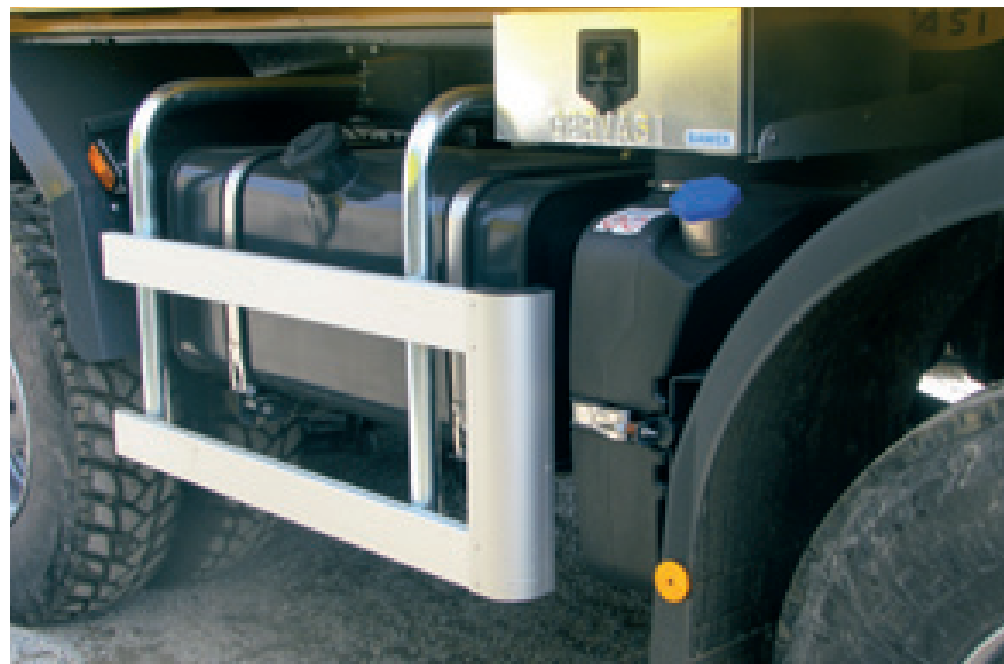
Il serbatoio del carburante che alimenta il 6 cilindri Cursor 13 da 450 cavalli montato sul Trakker oggetto del nostro test. Un propulsore che non mostra mai un cedimento.
