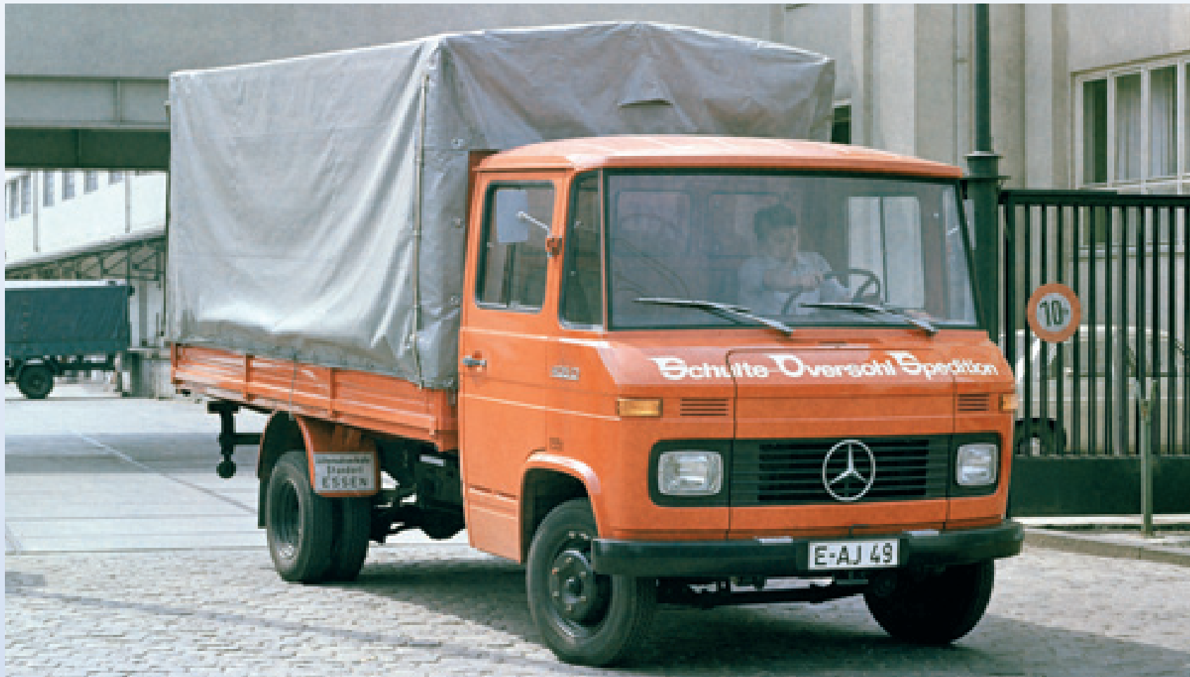
Un Mercedes-Benz L 406 D pick-up del 1969. Con la denominazione L 406 D viene identificato un veicolo con Ptt da 3,5 a 4,6 tonnellate.
