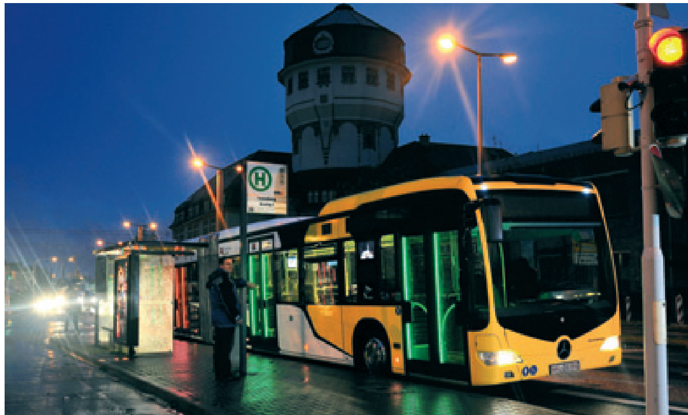
Innovativi sistemi di comunicazione visiva: verde significa che i passeggeri possono entrare da quella porta, rosso indica il contrario.
