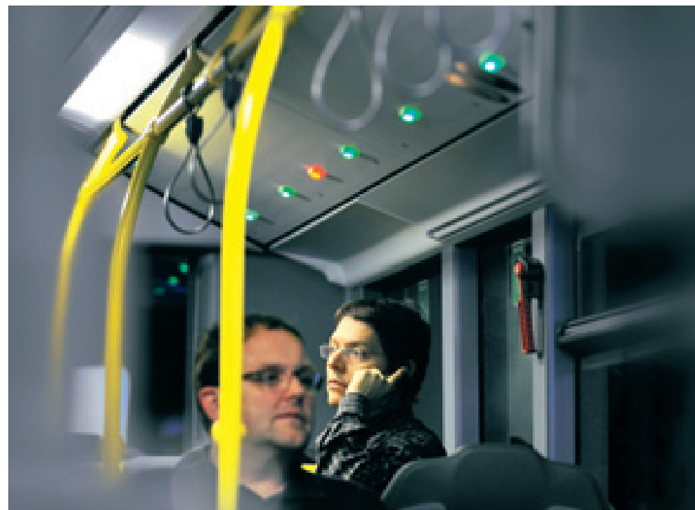
Un sistema d'identificazione del sedile con le luci sopra i sedili è destinato a controllare i flussi dei passeggeri lungo i corridoi. Un utile strumento per verificare la disponibilità di posti a bordo.
