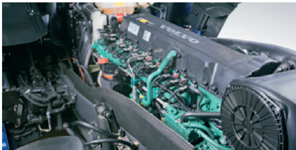
La tecnologia dell'FM MetanoDiesel si basa su un motore Diesel dotato di iniettori per il gas.
