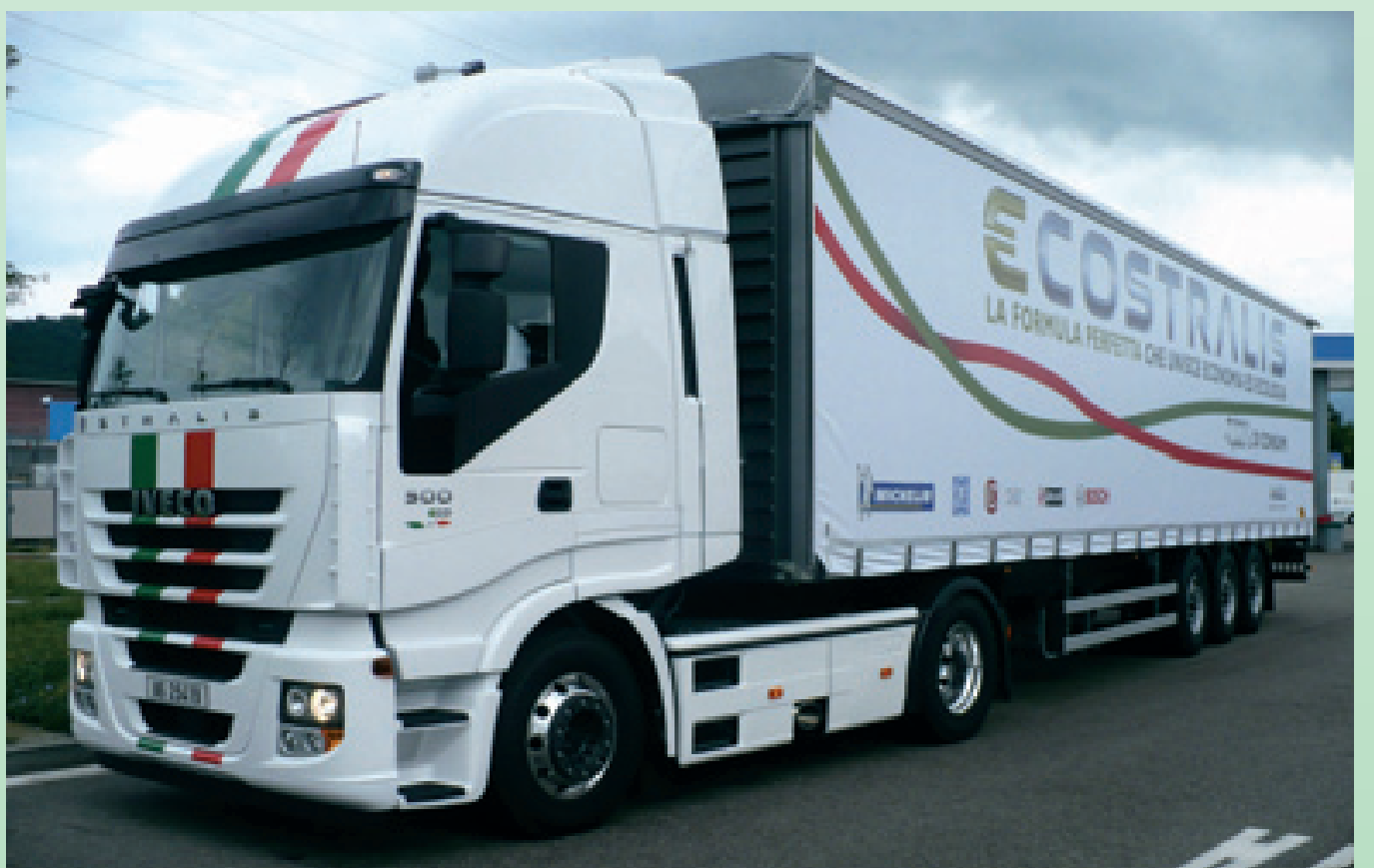
In alto l'Ecostralis AS440S46E sul quale abbiamo effettuato il test drive organizzato in occasione della prima tappa veronese dell'Ecostralis Tour. È dotato di motore Cursor 10 da 460 cv. Sopra, un altro veicolo della nuova gamma proposta da Iveco.
