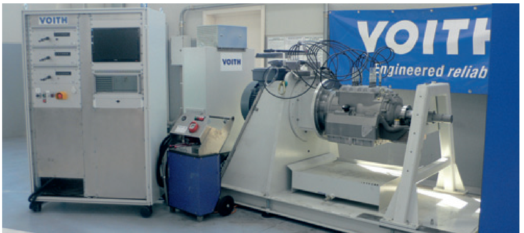
L'avanzato banco prova Voith consente di rilevare i valori e di effettuare prove elettroniche ed elettroidrauliche del cambio con una garanzia assoluta finale per il cliente.
