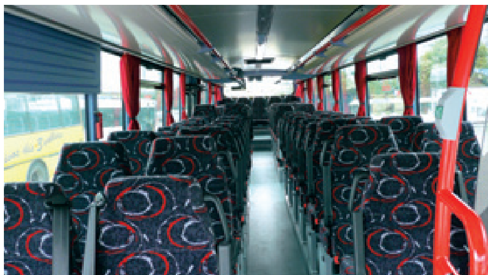
I sedili del Crossway HV sono del tipo Lineo con cinture di sicurezza a scomparsa.
