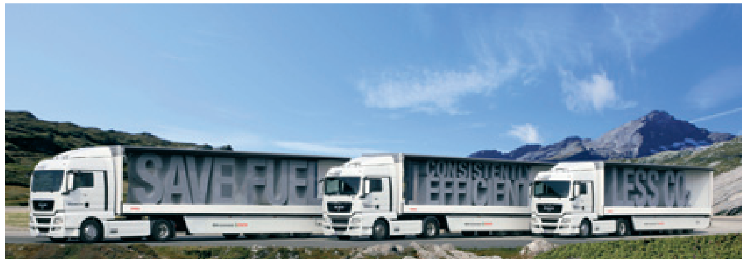
I Man TGX EfficientLine impegnati nel tour di 11.500 km hanno registrato un consumo inferiore ai 3 litri per 100 km rispetto a veicoli di riferimento.
