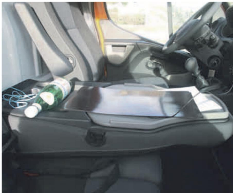
L'ampio spazio ricavato sul retro dello schienale del sedile centrale può accogliere un pc portatile.
