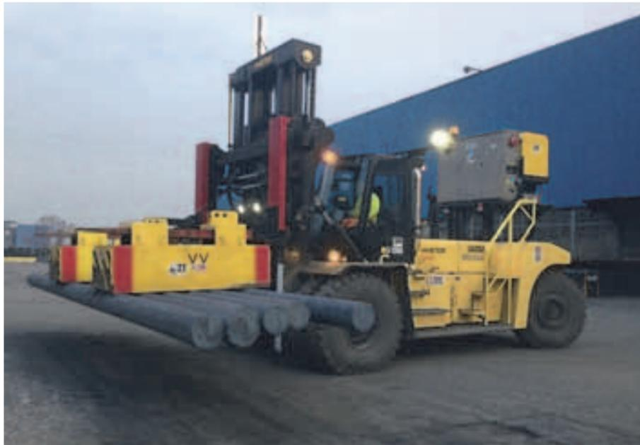
kW alimentata da un generatore. Per ottimizzare la visibilità posteriore, il generatore è installato in posizione strategica sul contrappeso del nuovo carrello Hyster. Il carrello trasporta le barre dall'altoforno all'area di stoccaggio
