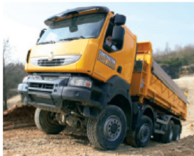
La versione 8x8 del possente Kerax Xtrem dispone di ben otto ruote motrici con due assi sterzati davanti e due assali motori dietro.
