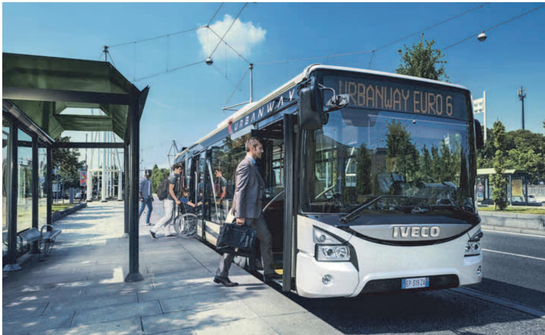
Ormai al completo, la gamma **Urbanway** di **Iveco Bus** viene proposta in tre lunghezze (10,50 m, 12 m e 18 m), tre motorizzazioni (diesel, CNG e ibrido elettrico) e più versioni.
