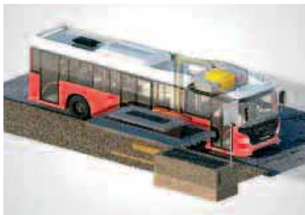
La grafica che illustra il servizio di ricarica rapida wireless (induttiva) alla fermata dell'autobus.
