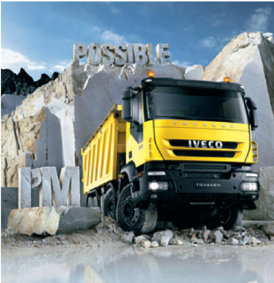
Il design del Trakker è stato rinnovato nella parte esterna della cabina con una nuova griglia centrale, cantonali riprogettati, paraurti ottimizzati e gruppi ottici di grandi dimensioni (e dotati di protezione).
