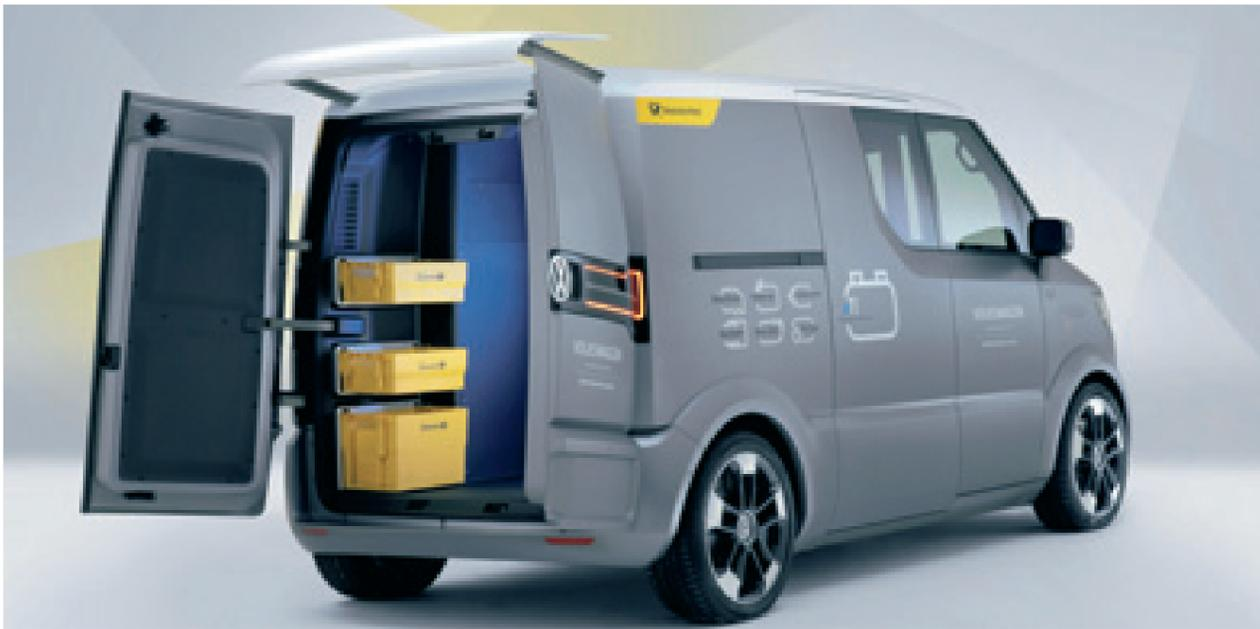
Il Volkswagen eT! è lungo 4.090 mm, largo 1.850 mm e alto 1.980 mm. Il passo misura 2.780 mm. Il rapporto tra lunghezza e passo lascia intuire lo sfruttamento ottimale dello spazio. Infatti, il volume di carico arriva alla considerevole misura di 3,6 metri cubi.
