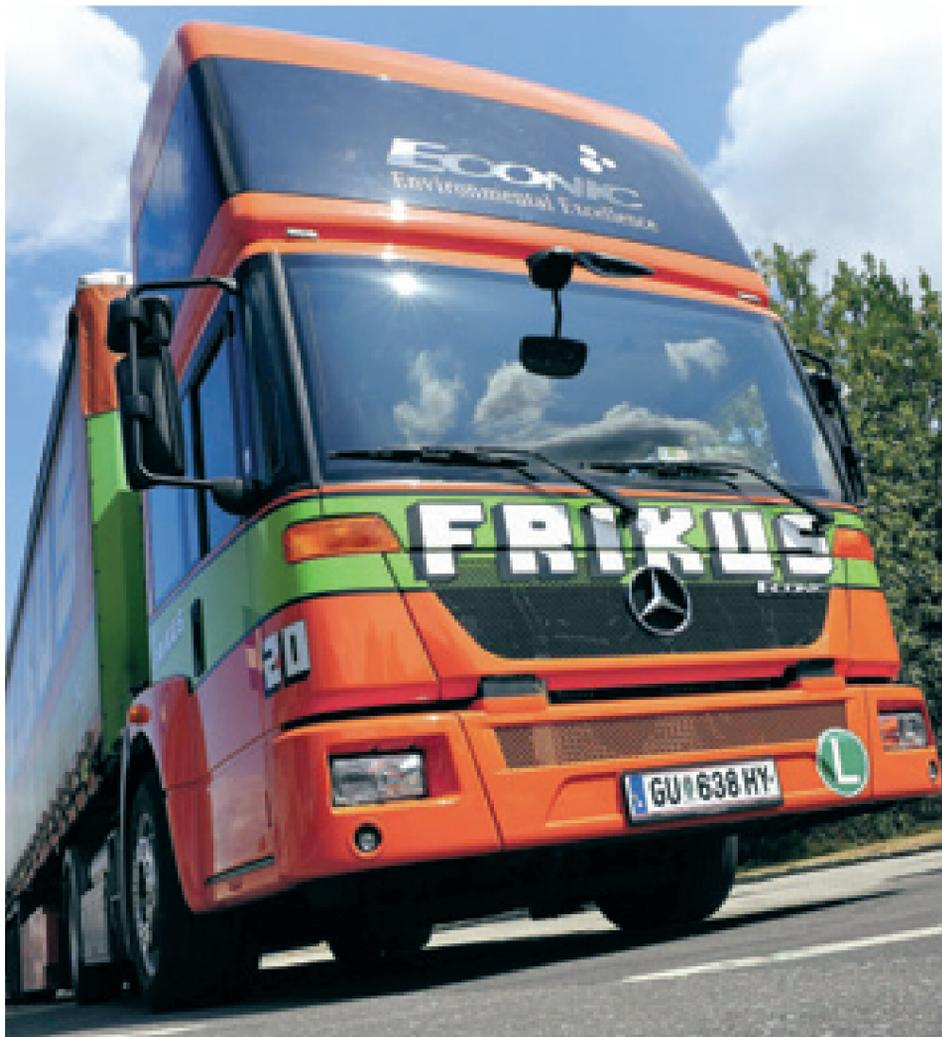
L'Eonic NGT, con motore OM 906 da 6.9 litri a gas naturale erogante 205 kW (279 cv) di potenza, è allestito esclusivamente con una trasmissione completamente automatica Allison 3500R a sei velocità.
