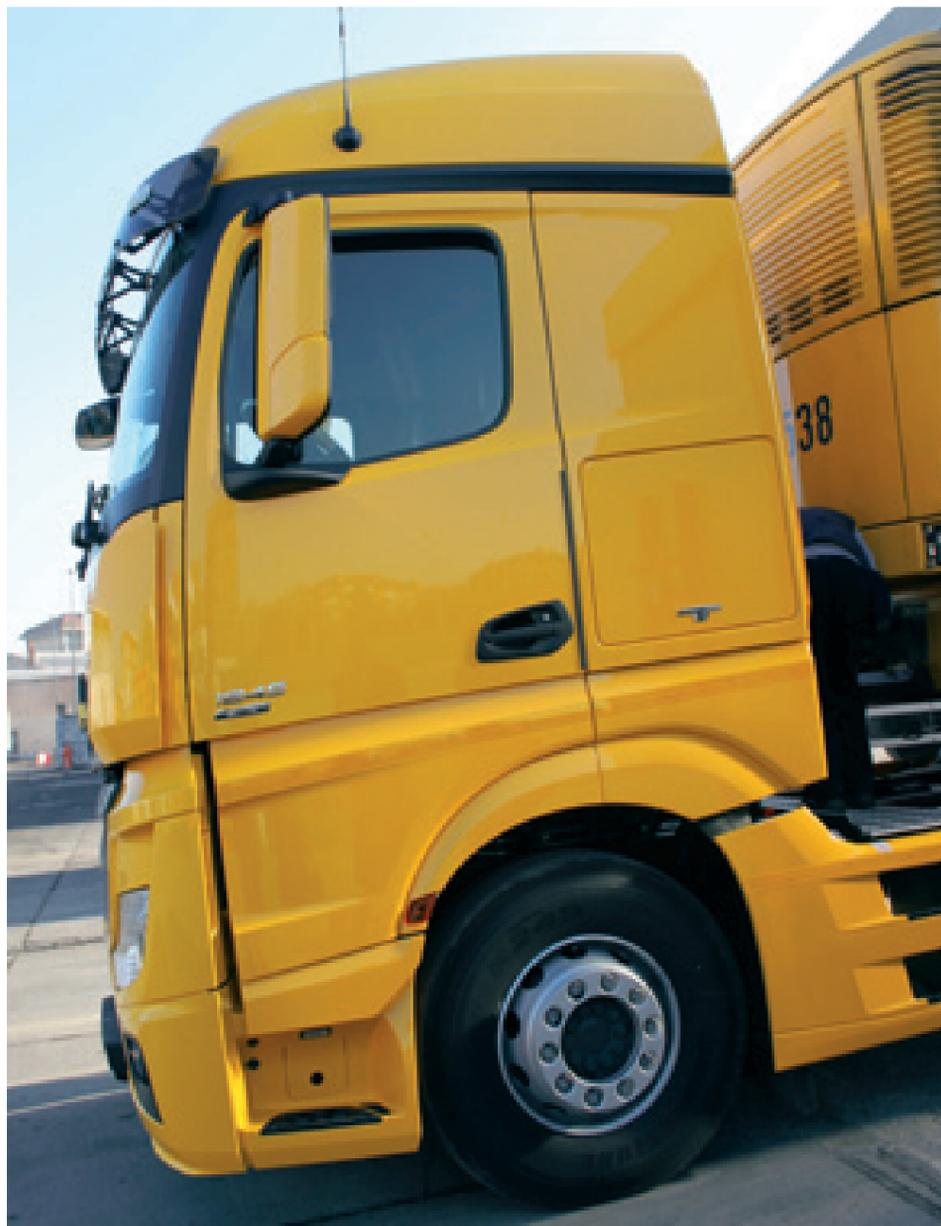
La configurazione scelta è quella classica da flotta, con motore Euro 5 e potenza di 450 cv, cabina StreamSpace larga di 2,5 metri, cioè la miglior soluzione aerodinamica, insuperabile nei consumi.
