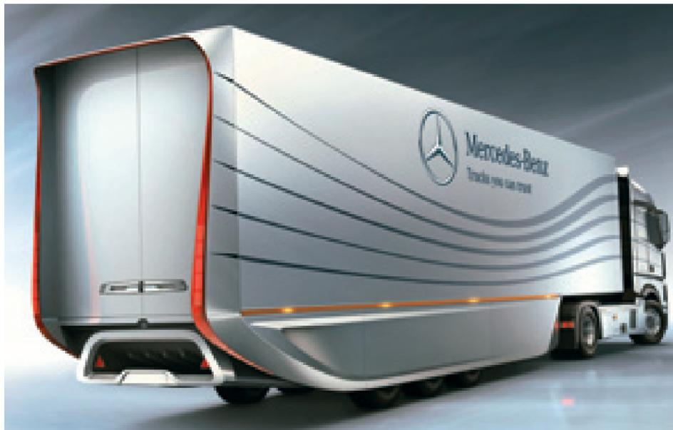
Il prominente diffusore posteriore di Aero-Trailer ha la forma di un parallelogramma e si raccorda al rivestimento del sottoscocca, migliorando la resistenza aerodinamica.
