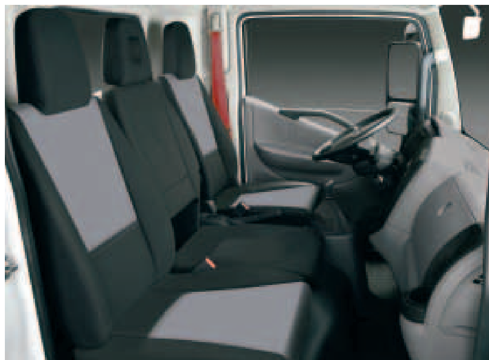
Nella configurazione a tre sedili, il sedile centrale è munito di un piano utilizzabile a schienale abbassato.
