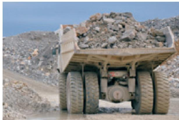
I dumper trasportano circa 55 tonnellate per ogni viaggio. Un peso ingente, una sollecitazione del mezzo e della meccanica continua. Di qui la scelta delle trasmissioni automatiche Allison, abbinata ai mezzi Perlini, idonei agli impieghi heavy-duty.
