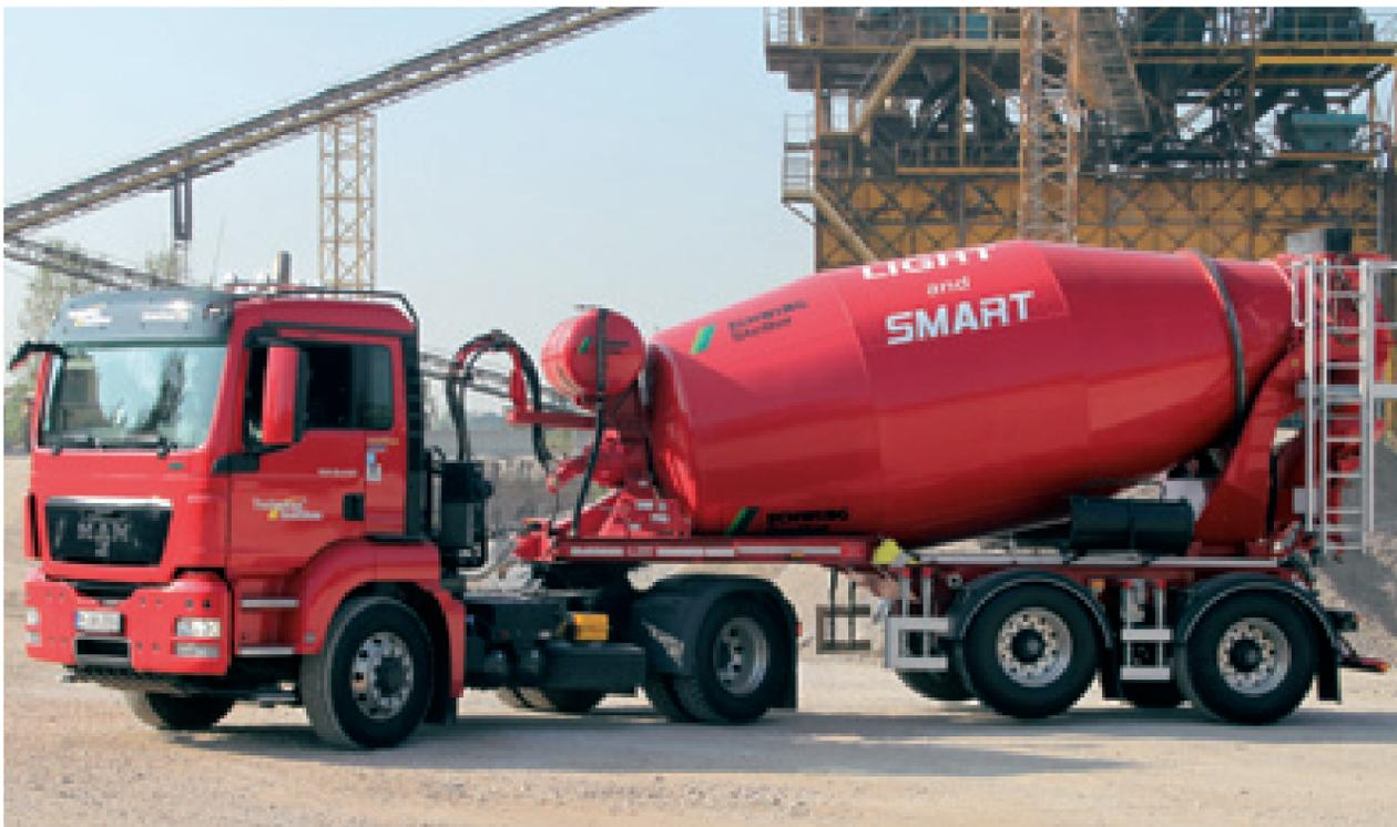
Un Man TGS trattore 18.440 BLS, con cabina media, abbinato a una betoniera. Il particolare più interessante è l'aggiunta dell'HydroDrive, che trasforma (parzialmente) il classico due assi in un veicolo a trazione integrale. Il sistema non incide sulla carrozzabilità del veicolo.
