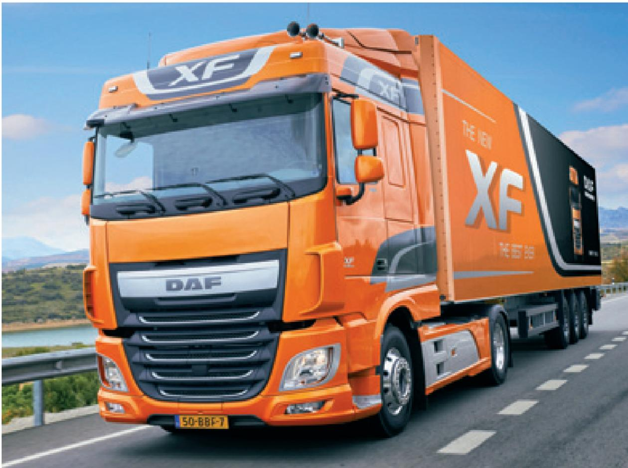
Tra le dotazioni più importanti dell'XF105 Euro 6 c'è l'Eco Roll fornito di serie, che contribuisce alla riduzione dei consumi. Al freno motore potenziato può essere aggiunta anche la versione 3 dell'Interder ZF, con una potenza frenante fino a 500 kW.
