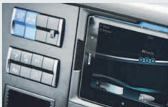
Ecco come si forma un convoglio: il conducente di un autocarro attiva il sistema Highway Pilot con l'apposito tasto blu, passando così dalla guida manuale a quella automatizzata. Il sistema Highway Pilot trasmette il segnale "Highway Pilot Connect available". Se un altro autocarro desidera agganciarsi, il suo conducente preme un secondo tasto, questa volta azzur-
