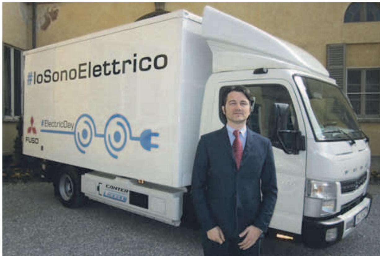
ZERO EMISSIONI E TOTALE SILENZIOSITÀ DI MARCIA, POTENTE MOTORE ELETTRICO DALLA COPPIA ELEVATA, FINO A 100 KM DI AUTONOMIA, COSTI DI ESERCIZIO RIDOTTI DEL 64 PER CENTO RISPETTO ALLA VERSIONE DIESEL. SONO LE PRINCIPALI CARATTERISTICHE DEL FUSO CANTER E-CELL, PRONTO A SBARCARRE SUL MERCATO PROPONENDOSI COME VEICOLO PERFETTAMENTE ADATTO ALLE ATTIVITÀ DI TRASPORTO QUOTIDIANE NEI CENTRI URBANI DELLE METROPOLI EUROPEE, SEMPRE PIÙ PROTETTI DALLE ZTL.
