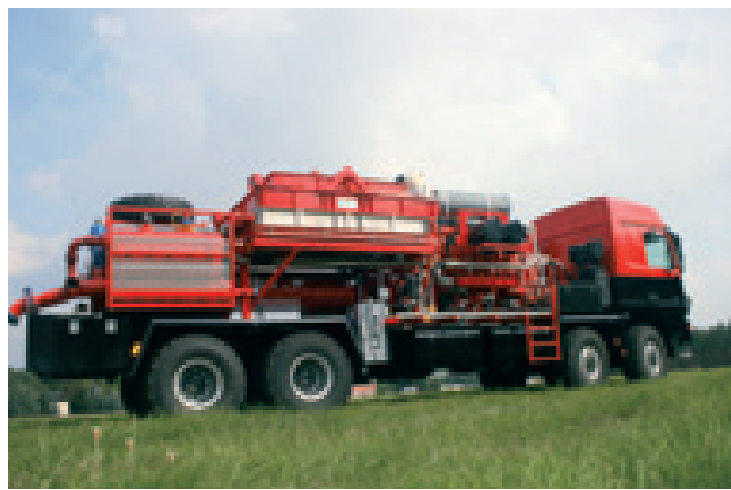
Un'unità C.A.T.: la trasmissione completamente automatica Allison a sette marce S9820M trasferisce la potenza alla pompa ad alta pressione Triplex da 5 pollici installata sul telaio di un camion.
